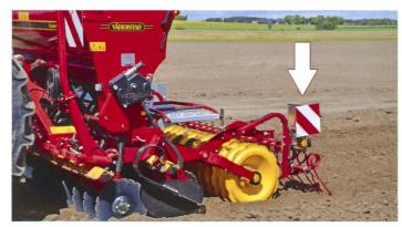
Markierungstafeln mit Rückstrahler sind vorne und hinten erforderlich. Eine grosszügige, seitliche Signalisationstafel ist sicher von Vorteil, wenn die gut sichtbaren Maschinenteile nach hinten stark abnehmen.
