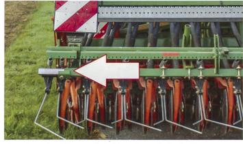
Dieser Saatstriegel überragt die limitierte Gesamtbreite der Sämaschine. Der Hersteller hat bereits vorgesehen, dass das äusserste Element auf einfache Weise eingeschoben oder entfernt werden kann.
