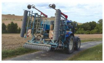
Bei trockenen Bodenbedingungen kann bei der Saat bzw. bei der Kombination von Bodenbearbeitung und Saat Staub entstehen, der auch an Signalisationstafeln anhaftet. Diese sind folglich noch auf dem Feld zu reinigen, damit sie ihre «Signalwirkung» auch wirklich entfalten können.
