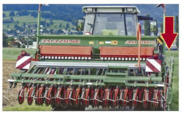
VTS Art. 67: «Fahrzeuge dürfen keine scharfen Spitzen, Kanten oder Vorsprünge aufweisen, die bei Kollisionen, namentlich mit Fussgängern oder Zweiradfahrern, eine zusätzliche Verletzungsgefahr darstellen.»
