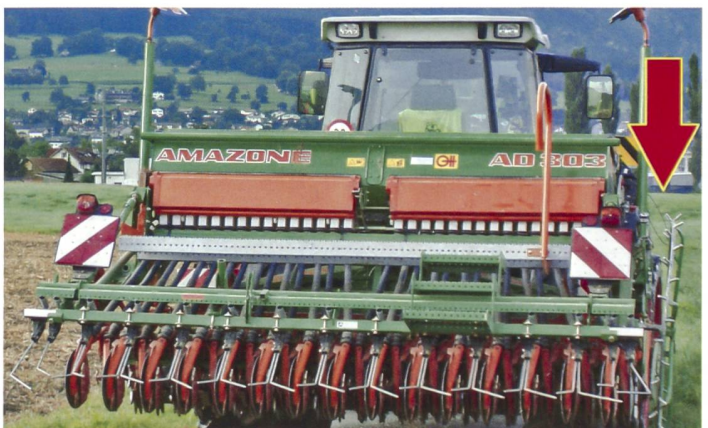
VTs Art. 67: «Fahrzeuge dürfen keine scharfen Spitzen, Kanten oder Vorsprünge aufweisen, die bei Kollisionen, namentlich mit Fussgängern oder Zweiradfahrern, eine zusätzliche Verletzungsgefahr darstellen.»
