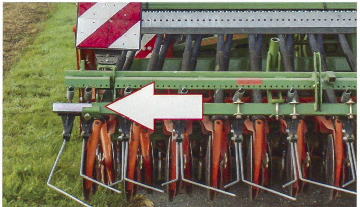
Dieser Saatstriegel überragt die limitierte Gesamtbreite der Sämaschine. Der Hersteller hat bereits vorgesehen, dass das äusserste Element auf einfache Weise eingeschoben oder entfernt werden kann.
