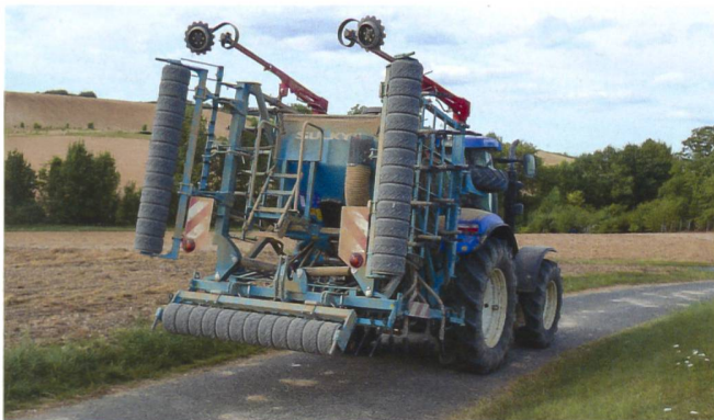
Bei trockenen Bodenbedingungen kann bei der Saat bzw. bei der Kombination von Bodenbearbeitung und Saat Staub entstehen, der auch an Signalisationstafeln anhaftet. Diese sind folglich noch auf dem Feld zu reinigen, damit sie ihre «Signalwirkung» auch wirklich entfalten können.
