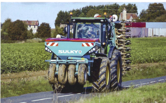
VTs Art. 164 und VRV Art. 65, 73: Fahrzeugteile oder Zusatzgeräte (vorderer Überhang) dürfen gemessen ab Mitte Lenkrad bis 4 m, Ladung bis 3 m nach vorne reichen. Das kantonale Strassenverkehrsamt kann evtl. Ausnahmegewilligungen ausstellen.
