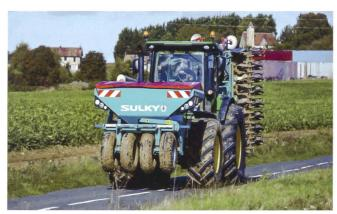
VTS Art. 164 und VRV Art. 65, 73: Fahrzeugteile oder Zusatzgeräte (vorderer Überhang) dürfen gemessen ab Mitte Lenkrad bis 4m, Ladung bis 3m nach vorne reichen. Das kantonale Strassenverkehrsamt kann evtl. Ausnahmebewilligungen ausstellen.
