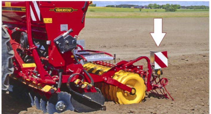
Markierungstafeln mit Rückstrahler sind vorne und hinten erforderlich. Eine grosszügige, seitliche Signalisationstafel ist sicher von Vorteil, wenn die gut sichtbaren Maschinenteile nach hinten stark abnehmen.
