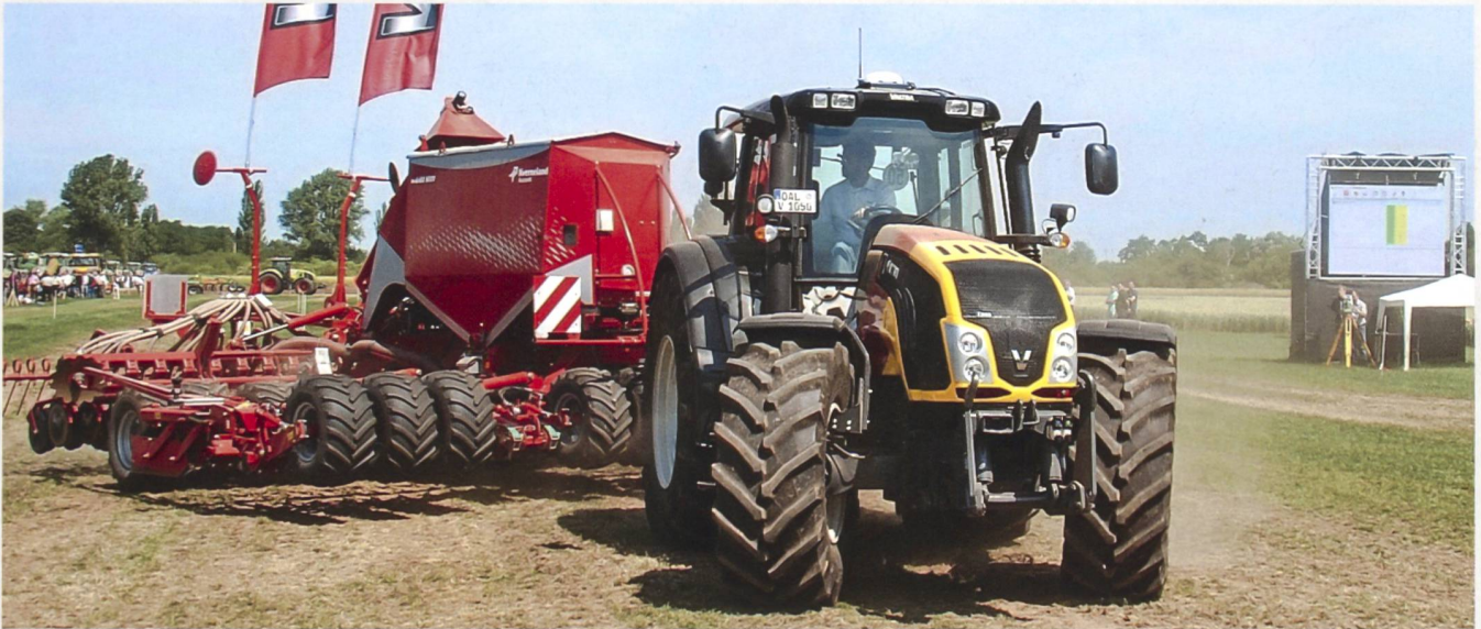
Gespann eines Valtra-T-Serien-Traktors und einer Kverneland Accord msc 6000 Drillmaschine auf Slalomfahrt, hinten rechts die Kamera, die den Messpunkt am Anbaugerät anvisiert und die Abweichung (grün plus gelb) sogleich auf dem Grossdisplay anzeigt.
