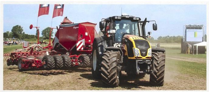
Gespann eines Valtra-T-Serien-Traktors und einer Kverneland Accord msc 6000 Drillmaschine auf Slalomfahrt, hinten rechts die Kamera, die den Messpunkt am Anbaugerät anvisiert und die Abweichung (grün plus gelb) sogleich auf dem Grossdisplay anzeigt.
