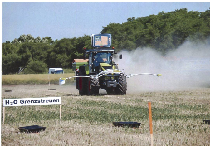
Mit einem Grossdisplay visualisiert Claas die Messresultate des Crop Sensors, auf dem Bild beim Grenzstreuen mit dem Amazone ZAM profis Hydro. Auf der Rückfahrt wird nicht gestreut, sondern eine Displayanzeige auf dem Traktordach zeigt an, welche Düngerdosis der jeweilige Sensor empfiehlt.
