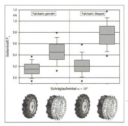
Die übertragbaren Seitenkräfte für ein AS-Profil-Rad und die Radkombination AS-Rad/Rapid-Stachelrad werden durch die Grasauflage negativ beeinflusst.
