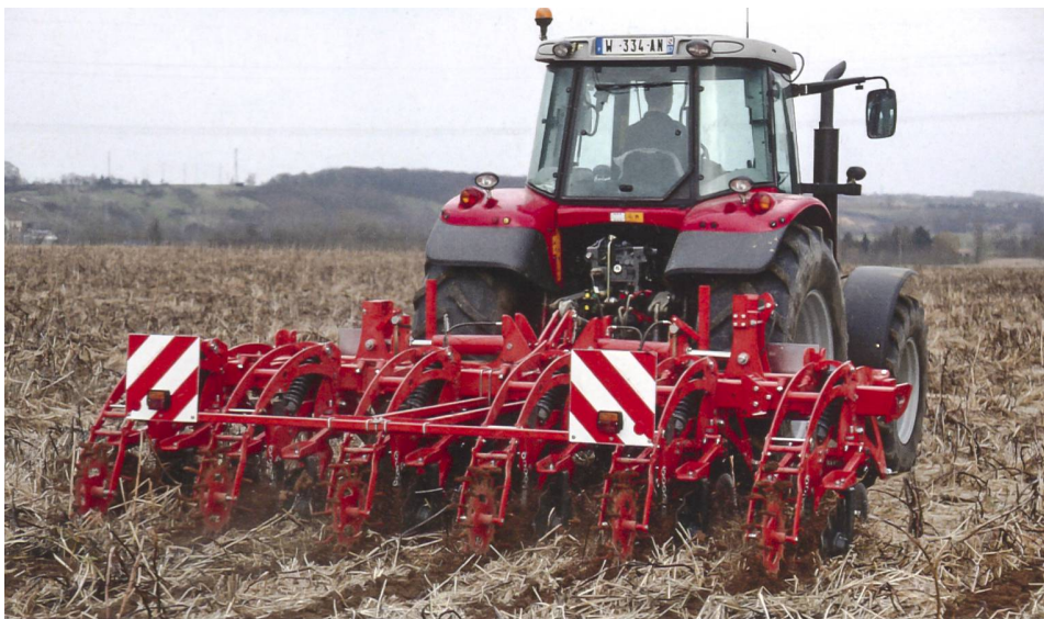
Das absätzige Verfahren, wie es durch den Striger von Kuhn verkörpert wird, schafft gute Voraussetzungen für Boden, Saat und Auflaufen. (Werkbild)
