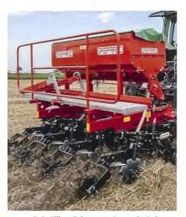
Strip-Tiller «Zebra» von Gaspardo. Robuste, Parallelogramm geführte Säschare erlauben eine hohe Arbeitsgeschwindigkeit trotz viel Ernterückständen und schwierigen Bodenverhältnissen.
