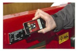
Auf dem Typenschild der seit Mai 2013 ausgelieferten Pöttinger-Maschinen ist ein QR-Code, der mithilfe einer geeigneten App auf dem Smartphone oder Tablet sämtliche Informationen zur Maschine abbildet. (Foto: Pöttinger).
