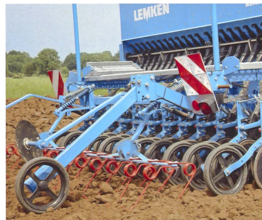
Ein Impulsrad erfasst die Fahrgeschwindigkeit für den elektrischen Säwellenantrieb.
