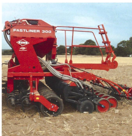
Bei mechanischen Sämaschinen entspricht die Arbeitsbreite ungefähr der Säkastenbreite.
