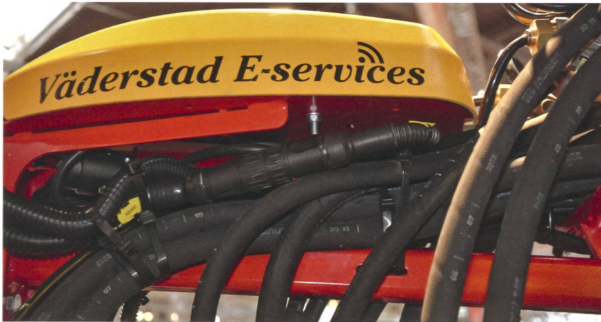
Das Gateway oder die sogenannte «Black-Box» auf der Tempo liefert die Daten an die von Väderstad freigegebenen virtuellen Bedienterminals. (Fotos: Ruedi Hunger)
