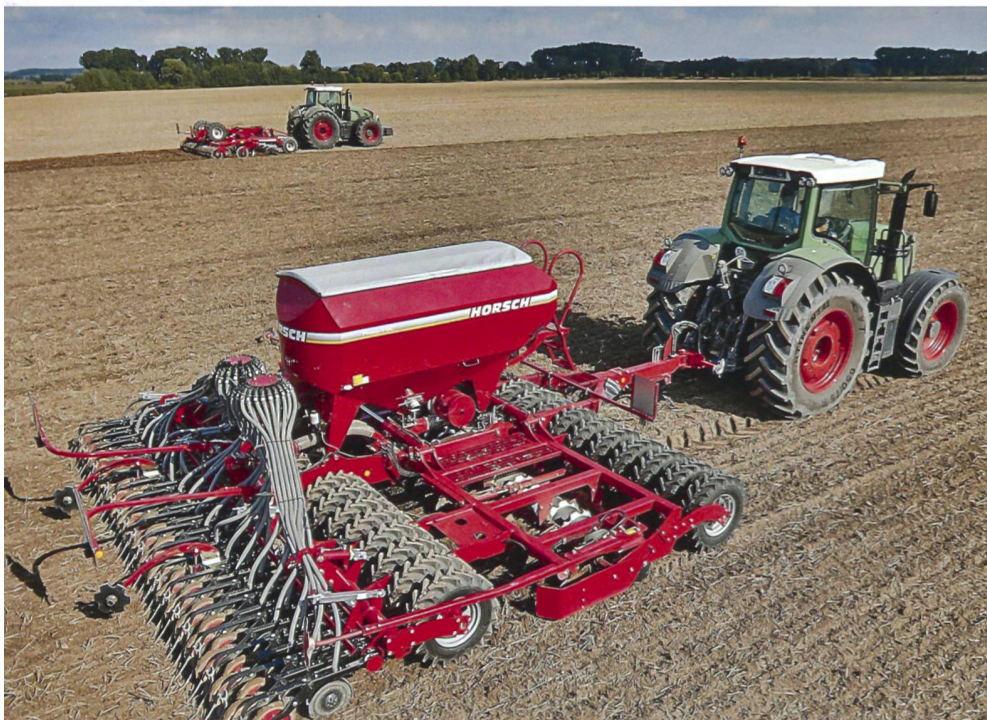
Die Horsch-Pronto kann mittels innovativer Dosiertechnik Getreide bei Fahrgeschwindigkeiten von bis 12 km/h hochpräzise ausbringen. (Werkbild)
