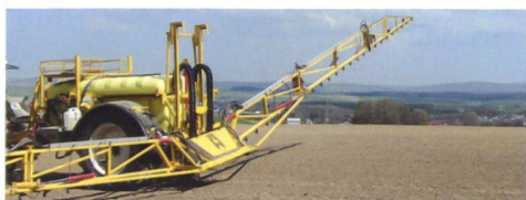
Dubex bietet optional Distance-Control mit Gestängeanwinkelung an. (Werkbild)
