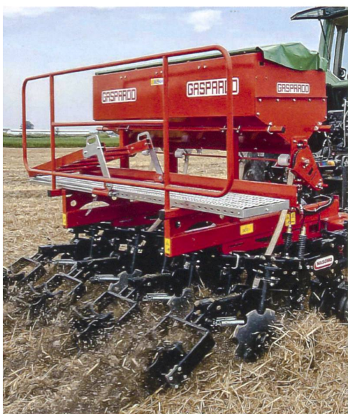
Strip-Tiller «Zebra» von Gaspardo. Robuste, Parallelogramm geführte Säscharer erlauben eine hohe Arbeitsgeschwindigkeit trotz viel Ernterückständen und schwierigen Bodenverhältnissen.
