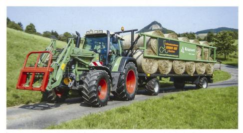
Elegante Ballensicherung auf dem Ballenwagen von Krassort: Durch die hydraulisch betätigten Seitenwände lassen sich Ballen und andere Ladegüter schnell und einfach sichern.
