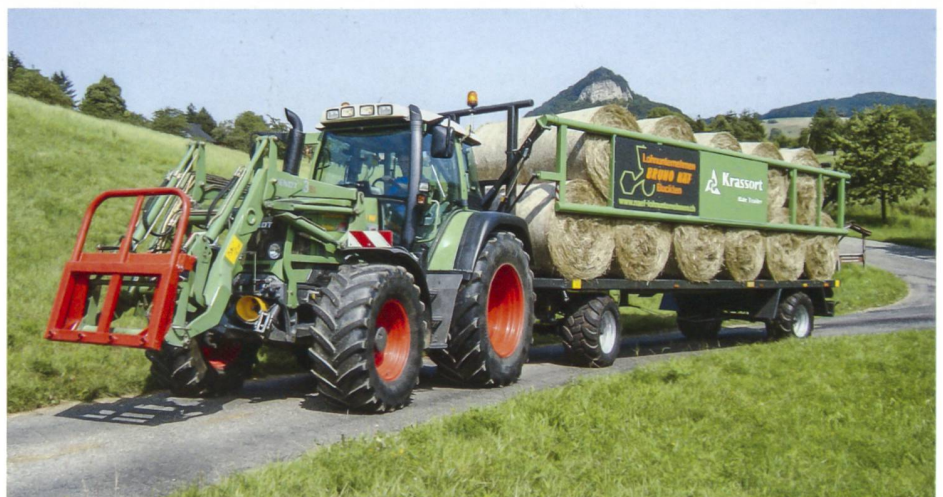
Elegante Ballensicherung auf dem Ballenwagen von Krassort: Durch die hydraulisch betätigten Seitenwände lassen sich Ballen und andere Ladegüter schnell und einfach sichern.
