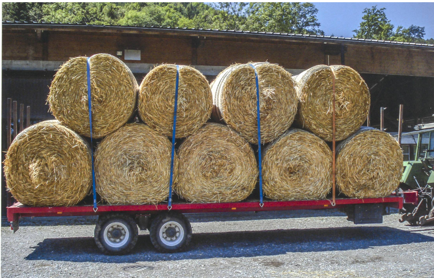
Formschluss nach vorne und hinten, Kraftschluss über Spanngurten. Nicht vergessen: die Gurten nachspannen. (Bilder: SVLT)
