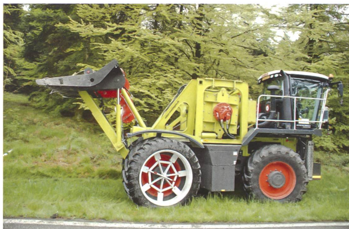
Der Claas Xerion 3800 Saddle Trac mit aufgebauter hydraulischer Reber-Seilwinde und Rückeschild.
