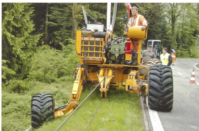
Der Menzi-Muck wird von der funkgesteuerten Seilwinde auf den Xerion zu gezogen.
