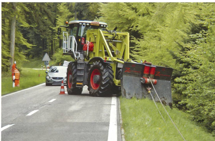
Der Xerion ist durch den Rückeschild fest verankert und zieht den Menzi-Muck heran.
