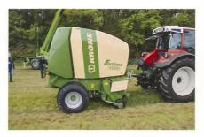
Die leistungsfähige neue Rundballenpresse Fortima F 1259 MC mit fixer Ballenkammer für Ballen von 1,25 m Durchmesser.
