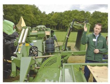
Matthias Sperver erläutert die Funktionsweise bzw. Anbauverbindungen und Inbetriebnahme der Querförderbänder des EasyCut.
