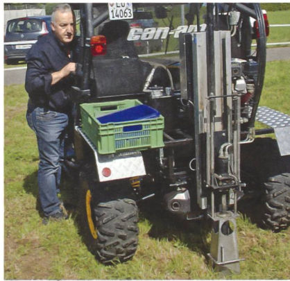
Lohnunternehmer Thomas Estermann führt die am Can-Am-Quad angebrachte Bohrvorrichtung vor.
