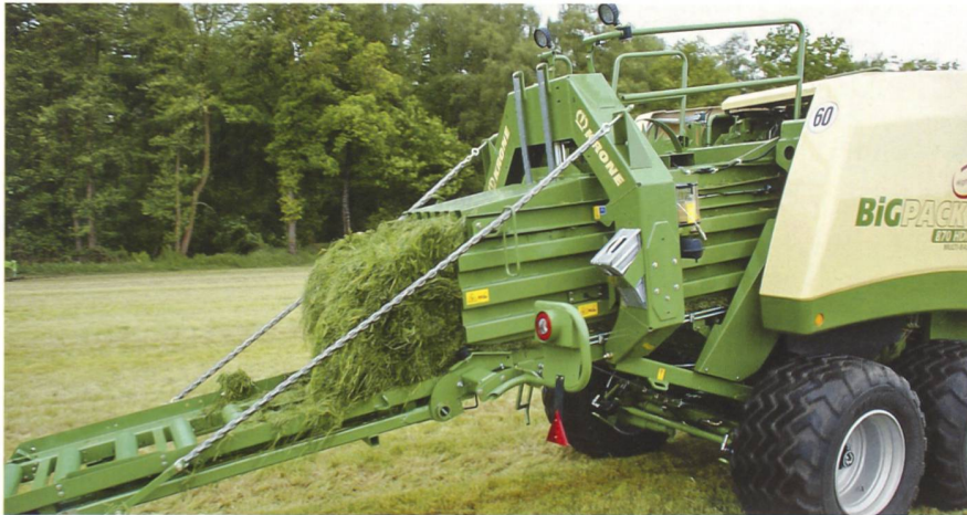
Die Grosspackenpresse BiG Pack HDP XC MultiBale hat Kanalabmessungen von 80 x 90 cm.
