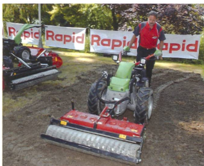
Thomas Meyer aus Remetschwil führt den öga-prämierten neuen Einachsgeräteträger Rapid Orbito vor. Per Tastendruck lässt sich sowohl die Achse bzw. die Gerätebalance während der Fahrt als auch die Wahl der Lenkungsarten (Handhebel oder Holm) einstellen; die Holmlenkung funktioniert kraftabhängig über die im Holm integrierten Sensoren. Dank einer zweiten integrierten Totmannfunktion lässt sich das Gerät auch mit einer Hand fahren.
