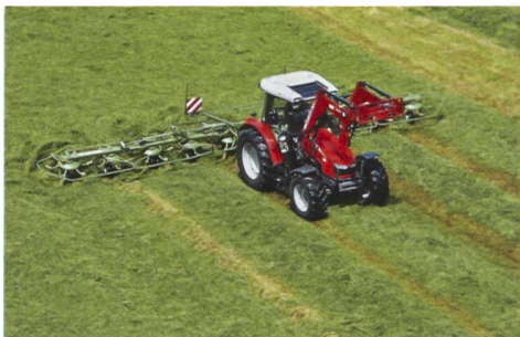
Der neue Anbauwender KW 11.22/10 mit zehn Kreiseln zu sechs Zinkenarmen.
