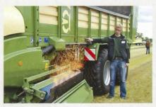
Der Schleifvorgang läuft: Pro Gruppe werden 23 Messer gleichzeitig geschliffen.
