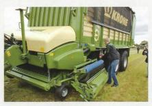
... und der Fahrer schliesst die Hydraulik an.
