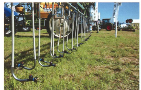
Die Droplegs werden in Übereinstimmung mit dem Reihenabstand der jeweiligen Kultur am Trägerbalken angeordnet.
