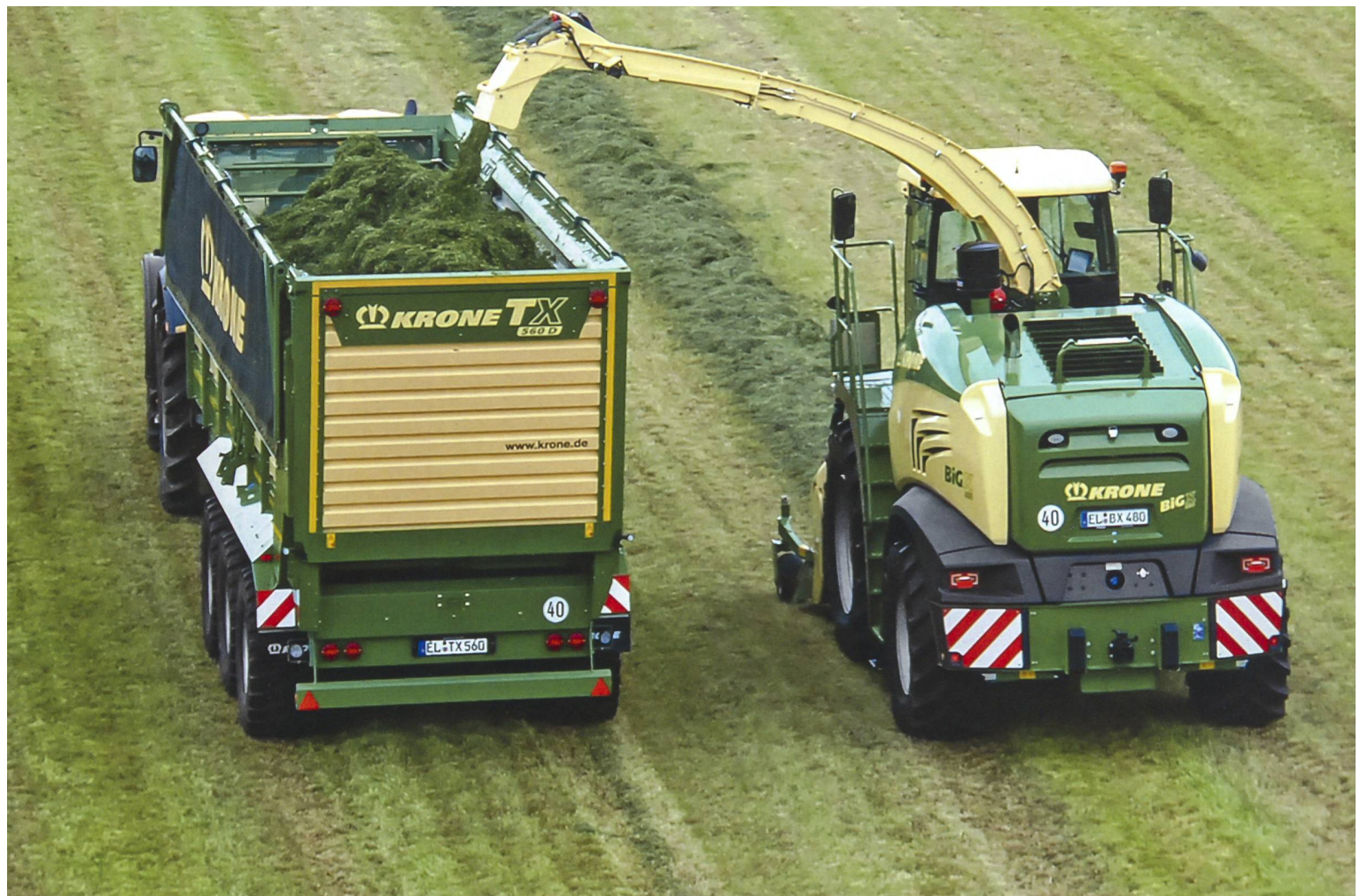
Krone hat in Spelle (D) als Weltneuheit den Häcksler BiG X 480 mit 489 PS Maximalleistung vorgestellt, hier gefolgt vom Häckseltransportwagen TX 560 D mit 56 m³ Volumen und Dosierwalzen. (Bilder: Dominik Senn)
