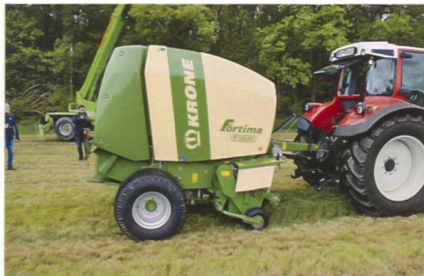
Die leistungsfähige neue Rundballenpresse Fortima F 1259 MC mit fixer Ballenkammer für Ballen von 1,25 m Durchmesser.
