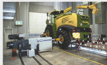
Der neue Radnabenprüfstand von Krone in Spelle misst die Leistungsdaten eines neu gebauten BiG X 580.
