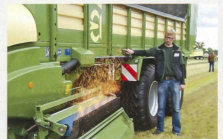
Der Schleifvorgang läuft: Pro Gruppe werden 23 Messer gleichzeitig geschliffen.
