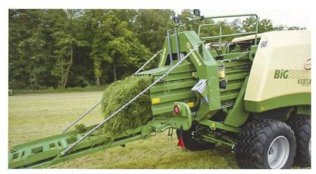
Die Grosspackenpresse BiG Pack HDP XC MultiBale hat Kanalabmessungen von 80 x 90 cm.
