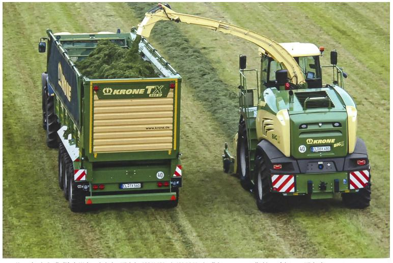
Krone hat in Spelle (D) als Weltneuheit den Häcksler BiG X 480 mit 489 PS Maximalleistung vorgestellt, hier gefolgt vom Häckseltransportwagen TX 560 D mit 56 m² Volumen und Dosierwalzen. (Bilder: Dominik Senn)
