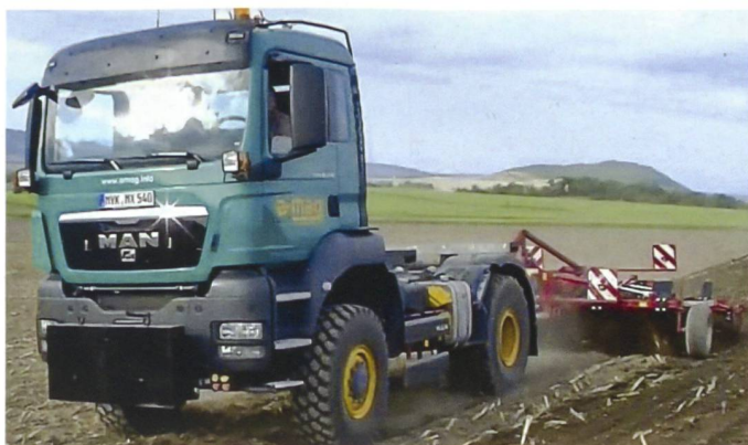
Echte Agrar-Trucks sind mit Zapfwelle, Hydraulikanlage und Hubwerk ausgerüstet und können bei Bedarf und guten Bedingungen nicht nur für Transporte eingesetzt werden.
