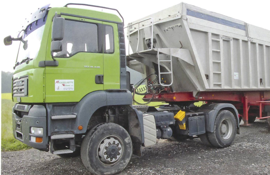
Der Sattelschlepper von Willi Wittwer ist mit einem mechanischen Allradantrieb und Reduktionsgetriebe ausgestattet. (Bild: Willi Wittwer)
