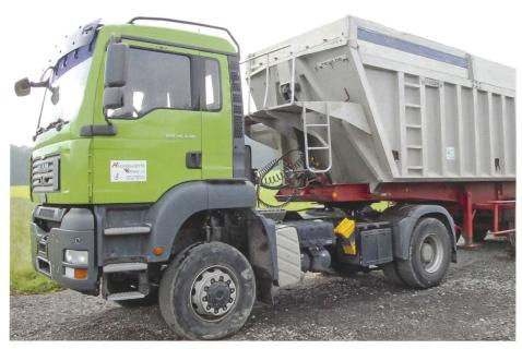
Der Sattelschlepper von Willi Wittwer ist mit einem mechanischen Allradantrieb und Reduktionsgetriebe ausgestattet. (Bild: Willi Wittwer)
