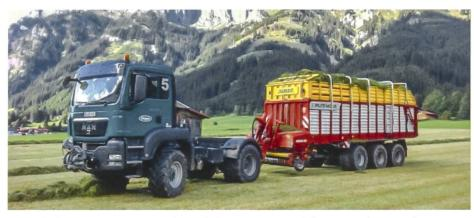
Dieses Gespann aus Agrar-LKW und Rotorladewagen wäre auch für Grastrocknungsanlagen und Lohnunternehmer in der Schweiz interessant. Das Einlösen als LKW mit über 40 km/h und bodenschonender Bereifung ist jedoch zurzeit in der Schweiz nicht möglich, da eine Breite von 2,55 m nicht überschritten werden darf. Der SVLT will sich der Problematik annehmen und mögliche Lösungen vorschlagen. (Bild: www.futtertrocknung-altendorf.de)
