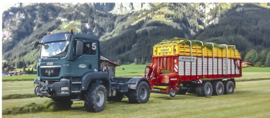
Dieses Gespann aus Agrar-LKW und Rotorladewagen wäre auch für Gastrocknungsanlagen und Lohnunternehmer in der Schweiz interessant. Das Einlösen als LKW mit über 40 km/h und bodenschonender Bereifung ist jedoch zurzeit in der Schweiz nicht möglich, da eine Breite von 2,55 m nicht überschritten werden darf. Der SVLT will sich der Problematik annehmen und mögliche Lösungen vorschlagen. (Bild: www.futtertrocknung-altendorf.de )
