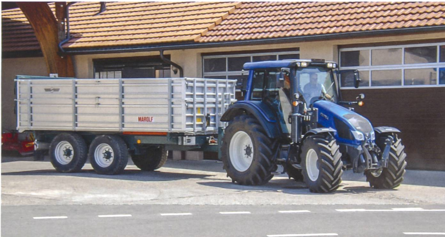
Die Vergleichsfahrt im gewohnten Fahrmodus und anschliessend im Eco-Drive-Modus führt zur Erkenntnis: Feine Getriebeabstufung hilft Treibstoff sparen, vor allem das Stufenlosgetriebe mit verminderter Motordrehzahl bei maximaler Fahrgeschwindigkeit. (Bilder: Dominik Senn)
