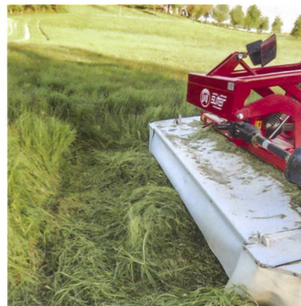
Schnittkante am stehenden Gras sichtbar, diese ist dank der grossen Klingenüberlappung fast gerade.
