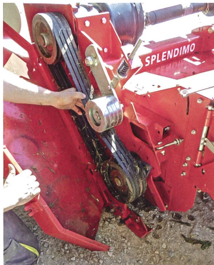
Vier Keilriemen mit Automatikspanner trieben den Aufbereiter an.
