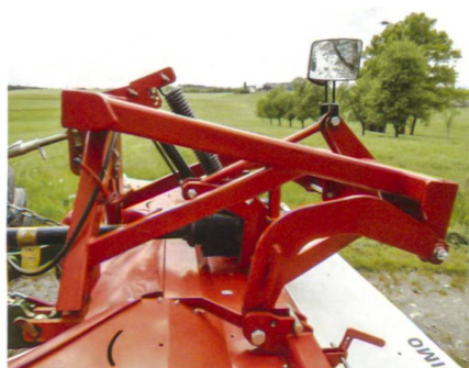
Gezogene Aufhängung für eine gute Boden Anpassung, links von der Feder ist der Hubzylinder montiert. Der in das Gestänge integrierte Hydraulikzylinder wird über einen Anschluss mit der Hubseite der Fronthydraulik gekoppelt und unterstützt das Ausheben des Mähwerks.
