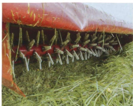
Der Impeller Aufbereiter von Lely reibt mit seinen 132 Kunststoffzinken die Wachsschicht von den Futterpflanzen, ohne diese zu knicken. (Bilder: Martin Abderhalden)
