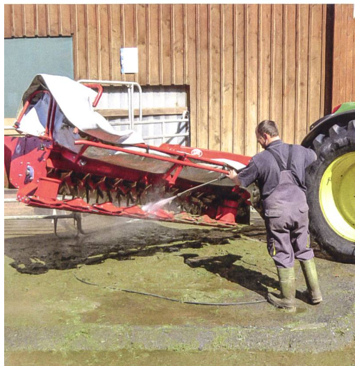
An beiden Mähwerken lassen sich die Schutztücher schnell und gut hochklappen, super für den Unterhalt.
