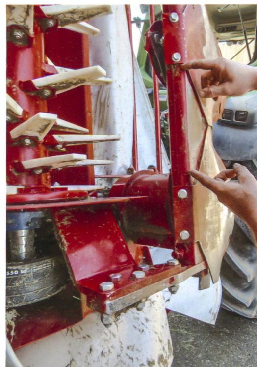
Ein Zwischenelement dient als Distanzhalter zu den separat verschlossenen Mäheinheiten.
