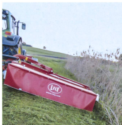
Mit einem Neigungswinkel von je 20° lassen sich auch Böschungen bearbeiten.
