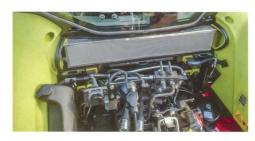
Der Kabinenluftfilter ist hinter der Kabine, angesaugt wird auf den Kotflügeln.
