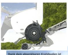
Dank dem absenkbaren Kratzboden ist der Förderweg beim Cargos sehr kurz, was eine Energieeinsparung ermöglicht.
