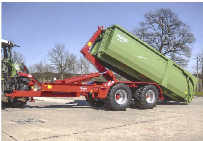
Hakenliftsysteme sind flexibel einsetzbar. Zudem passt es in die Logistikkette mit dem LKW.
