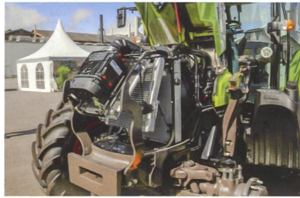
Alle Filter und Kühler sind für die Wartung und Reinigung gut zugänglich.
