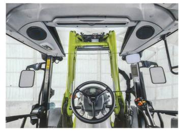
Die «Panoramic-Kabine» ermöglicht eine gute Sicht auf den Frontlader. Ein Schiebedach mit Rollo (oberes Bild) schützt vor der Sonne.
