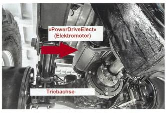
eine Antriebsachse. Elektromotor über der Fliegl «Self-propelled-Achse» (FSA).
