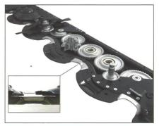
Die wellenförmige Wanne des geschraubten Balkens ermöglicht es, die Scheiben weit vorne zu montieren.
