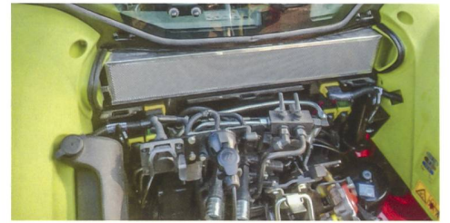
Der Kabinenluftfilter ist hinter der Kabine, angesaugt wird auf den Kotflügel.
