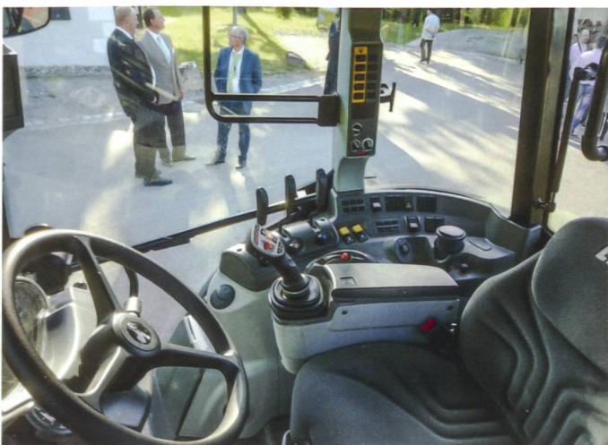
Am serienmässigen Multifunktionshebel auf der Armlehne werden die wichtigsten Funktionen bedient.
