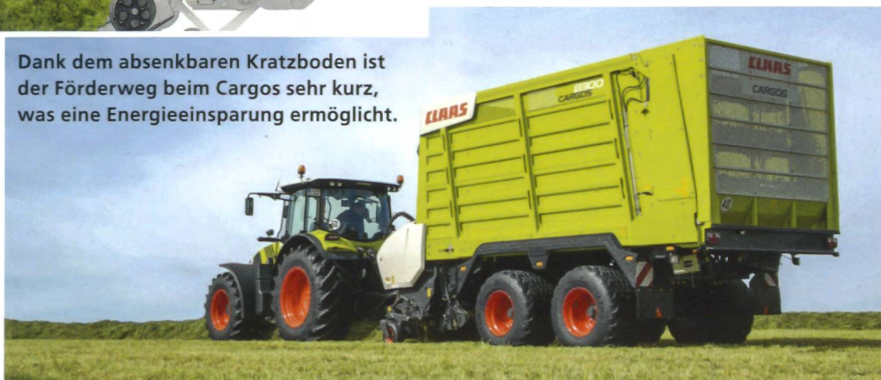
Den Cargos 8000 gibt es mit 30 bis 41 m 3 Ladevolumen. Das grösste Modell gibt es mit Tandem oder Tridemfahrwerk.
