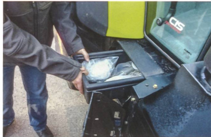
Über der Batterie befindet sich der praktische, herausziehbare Werkzeugkasten.
