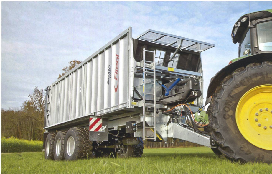
Gerade bei schwierigen Fahrbedingungen im Acker leistet eine angetriebene Anhängerachse wertvolle Unterstützung. (Werkbild)
