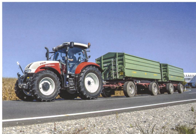
Der klassische Strassenzug mit zwei Zweiachs-Dreiseitenkipper bedingt ein genügend schweres Zugfahrzeug. (Bilder: Werkbilder/Ruedi Hunger)
