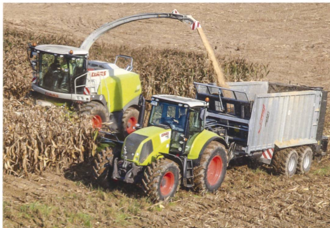
Abschiebewagen eignen sich aufgrund ihrer guten Standfestigkeit gut für Silierguttransporte auf den Fahrsilo.
