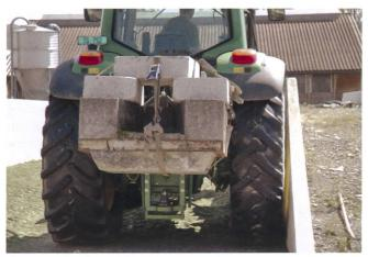
Walztraktor mit unterschiedlich breiter Bereifung.
