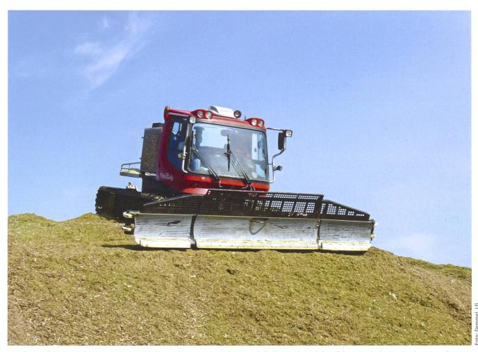
Mittels Pistenfahrzeugen lassen sich Silagen schnell verteilen. Trotz des tiefen Kontaktflächendrucks sind die Erfahrungen in der Praxis sehr gut. Bedingung ist, dass nur flache Schichten festgewalzt werden.
