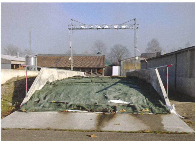
Dieser Flachsilo mit 6 m Breite und 26,5 m Länge diente für die Versuche. Oben im Bild ist die Ultraschallmessbrücke für die Volumenbestimmung des Silos sichtbar.
