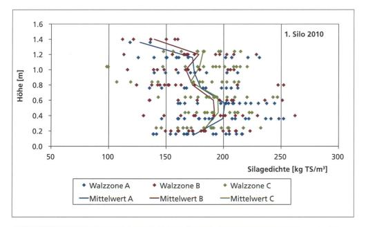
Abb. 2: Verteilung der Dichtewerte im 1. Silo 2010 abhängig von der Probenahmehöhe.
