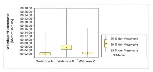
Abb. 4: Walzdauer pro Tonne Originalsubstanz (OS) für die Walzzonen aller untersuchten Silos
