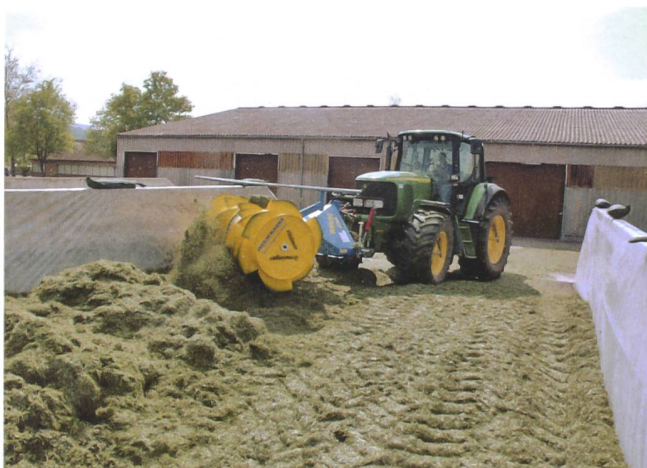
Siloverteiler ermöglichen die gleichmässige Verteilung des Futters, was eine wichtige Grundvoraussetzung für eine gute Futterqualität ist.
