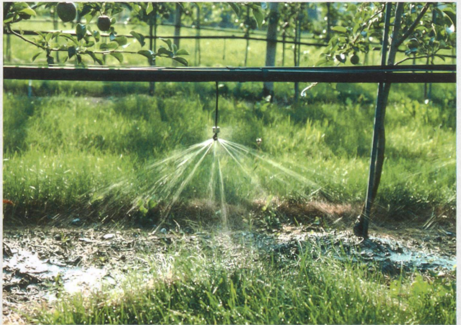
Der Mikrosprinkler in dieser Apfelkultur hat eine Reichweite von 1 bis 3 m, einen Düsendurchmesser von 0,8–1,6 mm, die Wassermenge pro Sprinkler beträgt 20 bis 50 l/h, die Wassermenge pro Fläche 35–50 m³/ha je Stunde. (Bild: Agroscope)
