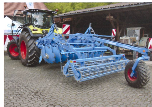
Aufsattelkonzept der Rubin-Kurz-scheibenegge mit Unirad, das ohne zusätzliches Steuergerät auskommt. Die gezackten Hohl-scheiben sind gegenständig aufgereiht, damit sich die Seitenzugkräfte nach links und rechts aufheben.
