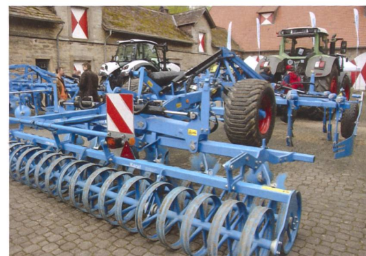
Karat 9 mit der Contourtrac-Arbeitstiefenregulierung, um den Boden in Senken und auf Kuppen in der gleichen Qualität zu bearbeiten. Optional werden die Gegenkräfte des Zinkeneinzugs und des Maschinengewichtes als Traktionsverstärkung auf die Traktorhinterachse übertragen.
