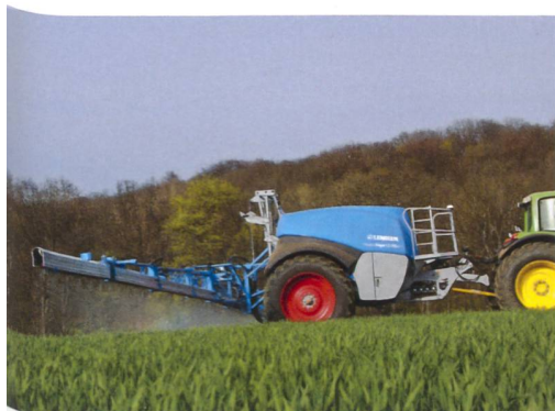
Dank einer neuartigen Kombination aus Parallelogramm und Hubmast lässt sich die Aushubhöhe des Gestänges zwischen 50 cm und 3 m variieren. (Bild Lemken)
