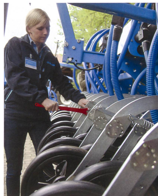
Die Druckintensität auf die Optidisc-M-Doppelschare lässt sich nunmehr in sechs Stufen mechanisch bis auf den maximalen Schardruck verändern.
