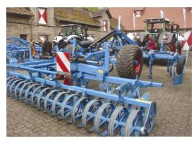
Karat 9 mit der Contourtrack-Arbeitstiefenregulierung, um den Boden in Senken und auf Kuppen in der gleichen Qualität zu bearbeiten. Optional werden die Gegenkräfte des Zinkeneinzugs und des Maschinengewichtes als Traktionsverstärkung auf die Traktorhinterachse übertragen.
