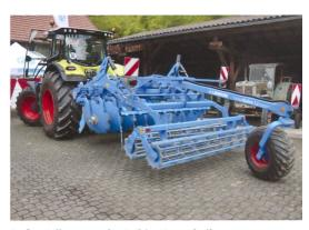
Aufsattelkonzept der Rubin-Kurzscheibenegge mit Unirad, das ohne zusätzliches Steuergerät auskommt. Die gezackten Hohlscheiben sind gegenständig aufgereiht, damit sich die Seitenzugskräfte nach links und rechts aufheben.
