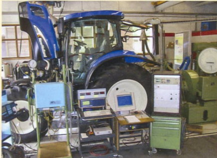
Harte Traktorentests: In Tänikon misst Agroscope den Energieverbrauch und die Emissionen landwirtschaftlicher Fahrzeuge.
