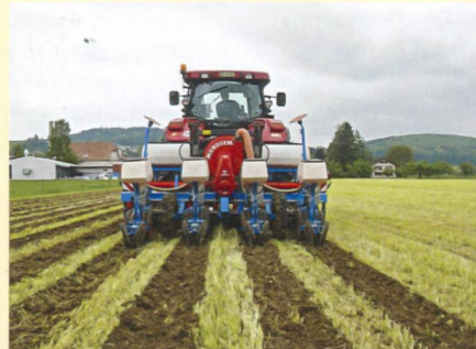
Die Streifenfrässaat ist eine schweizerische Entwicklung, die sichere Maiserträge und einen effizienten Bodenschutz bewirkt.
