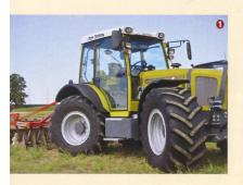
O Rigitrac SKH 120 ist das grösste Modell von inzwischen drei Stärkeklassen bei den Rigitrac-Traktoren. Diese sind mit hydrostatischem Fahrantrieb und Vierradlenkung ausgerüstet. Ihre Standfestigkeit und ihr Traktionsvermögen in Hanglagen verbessern sich durch die Verwindungsfähigkeit zwischen vorderem und hinterem Chassisteil. Der Rigitrac wird bei der Rigitrac Traktorenbau AG in Küssnacht am Rigi SZ gebaut. Dabei handelt es sich um eine Tochterfirma des Familienunternehmens Sepp Knüsel.
