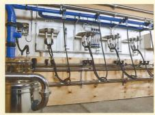
Mit der experimentellen Melkwand wird der Einfluss verschiedener Installations- und Montageformen auf die Vakuumstabilität in der Melkanlage analysiert.
