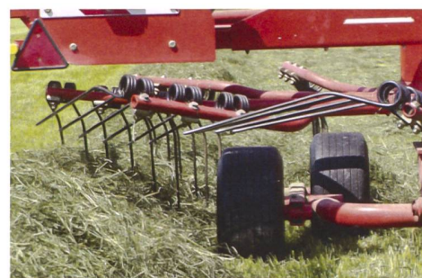
Eine geschwindigkeitsabhängige, automatisierte Arbeitshöheneinstellung wäre beim Kreisschwader ein echter Fortschritt.
