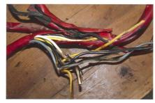
Zu stark belastete Leitungen erwärmen sich bis die Isolation schmilzt und die einzelnen Litzen untereinander metallischen Kontakt haben. Der ganze Kabelbaum ist zerstört und die nötige Reparatur aufwendig und teuer. Bei der Installation neuer Verbraucher ist daher zuerst zu klären, ob die vorhandenen Kabelguerschnitte für die zusätzliche Belastung ausreichen.
