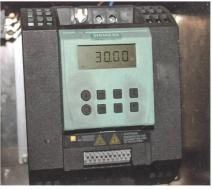
Frequenzumformer in der Ausführung mit Eingabetastatur und Frequenzanzeige auf dem Gerät. Eine Ferneinstellung über einen Drehknopf (Potentiometer) und eine Anbindung an eine Maschinensteuerung ist ebenfalls möglich.
