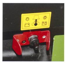
Kurzschluss im Bordnetz ist eine häufige Ursache von Fahrzeugbränden, auch bei abgestellten Fahrzeugen. Ein wirksamer Schutz ist ein Hauptschalter an gut zugänglicher Stelle. Mit einer intelligenten Schaltung kann die Zeitanzeige weiterlaufen. Wegen der schnell reagierenden Sicherung und der geringen Ströme ist aber ein brandverursachender Kurzschluss nach menschlichem Ermessen ausgeschlossen.
