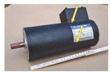
Der traditionelle Gleichstrommotor mit Kollektor und Kohlebürsten lässt sich sehr gut regeln und dürfte weiterhin die wirtschaftlichste Lösung für Einsätze ohne Dauerbetrieb sein, zum Beispiel beim Antrieb des Scheibenwischers oder der Streuscheibe eines Grassägerätes. Der hier abgebildete Motor hat trotz kleinen Abmessungen eine maximale Leistung von 4 kW. Die Kohlebürsten lassen sich bei diesem Modell von aussen wechseln (gelbe Pfeile).
