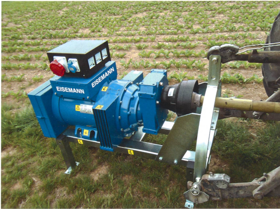
Notstromaggregate werden nicht nur bei Stromausfall, sondern auch als mobile Stromquelle abseits des Hofes eingesetzt. Dank dem technischen Fortschritt liesse sich heute ein Bordnetz mit genügender Leistungsfähigkeit für solche Zwecke in den Traktor integrieren. Ist dies die Lösung der Zukunft? (Bilder: Werkbilder/Ruedi Gnädinger)
