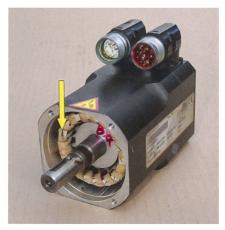
Beim Drehstrom-Synchronmotor befinden sich die Wicklungen im Stator und entwickeln das magnetische Drehfeld. Ein Kollektor mit mechanischem Verschleiss ist nicht vorhanden (Brushless DC Motor). Der Rotor ist mit Dauermagneten bestückt. Dies hat zur Folge, dass er synchron zum Drehfeld rotiert.
