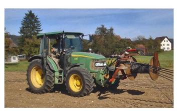
Nach der Ernte werden Einweg-Tropfschläuche maschinell eingesammelt und der Entsorgung zugeführt. (Bilder: Archiv)
