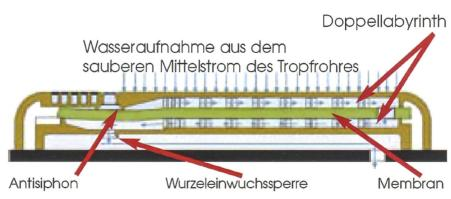
Druckkompensationssysteme arbeiten mit einem Doppellabyrinth.
