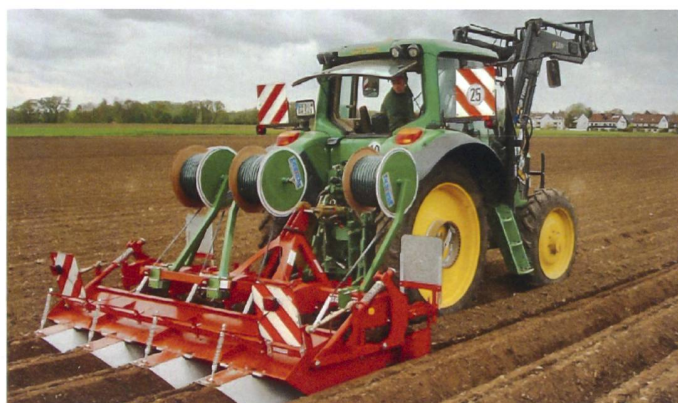
Im Kartoffelbau werden die Einweg-Tropfschläuche mit einem Dammformer oder einer Dammfräse eingezogen.
