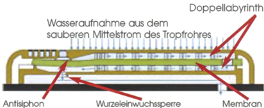
Druckkompensationssysteme arbeiten mit einem Doppellabyrinth.
