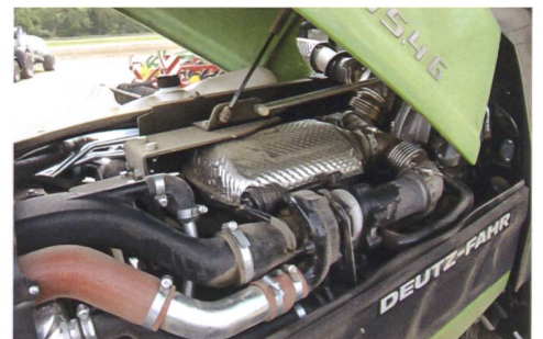
Der Dieseloxydationskatalysator (DOC) benötigt über dem Motor wenig Platz.
