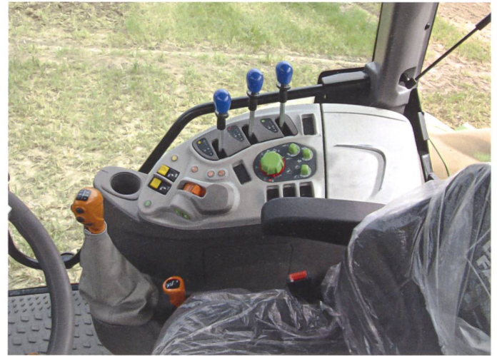
Die Bedienelemente auf der Seitenkonsole sind bei allen Deutz-Fahr-Traktoren mit den gleichen Farben gekennzeichnet.
