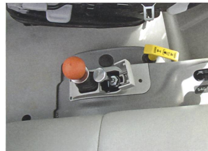
Mit diesem Hebel wird die neu erhältliche Federspeicher-Parkbremse bedient.
