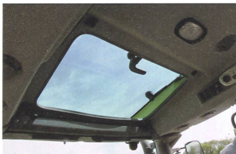
Das Freisicht-Dachfenster ermöglicht eine gute Sicht auf den angehobenen Frontlader.
