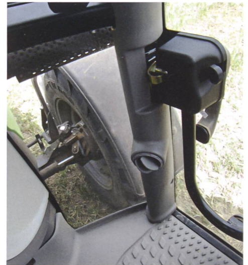
Auf beiden Seiten sorgt eine Luftdüse unten für warme Füsse.
