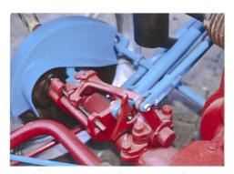
Die Schaltung des Aecherli Standard (auf dem Bild die rechte Seite): Zwei Hebel sind für die Vorwärtsgänge und zwei für die Rückwärtsgänge. Beim Einlegen des Rückwärtsganges wird der Vorwärtsganghebel automatisch ausgeschaltet.
