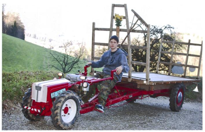
Martin Weber liebt es, mit seinem Triebachsanhänger am Aecherli MA-350 B mit Baujahr 1986, MAG-1045-Motor und 12-Gang-Getriebe samt kompletter Zapfwellenausrüstung auszufahren. (Bilder: Dominik Senn)
