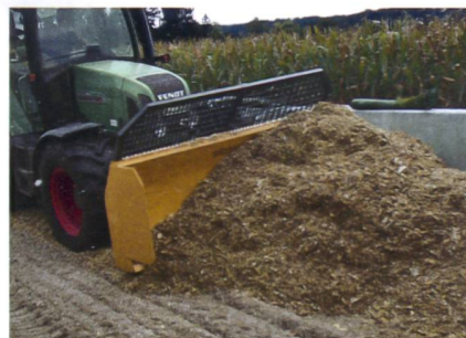
Hier ist links die 25-cm-Sohle des Schilds sichtbar, die ein zu tiefes Eindringen in das Futter verhindert.
