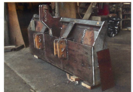
Dieser im Bau befindliche Schild ist mit einer Doppelwand für Zusatzballast in Form von Kies ausgestattet.
