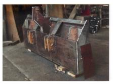
Dieser im Bau befindliche Schild ist mit einer Doppelwand für Zusatzballast in Form von Kies ausgestattet.
