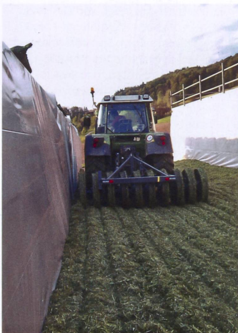
Die Silowalze sollte etwas breiter sein als der Traktor, damit man gefahrlos bis an den Rand verdichten kann. (Bilder: Martin Häberli)
