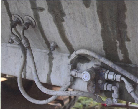
Volumenstromregulierung bei einem Druckfass für den innenliegenden Hydraulikmotor, welcher das Rührwerk antreibt. Solche Anwendungen haben ein erhöhtes Risiko für Ölverschmutzung und daraus entstehende Schäden.
