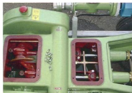
Bei den Pumpen der Meier AG sind das Kurbelgehäuse und der Ventilblock vollständig getrennt. Die in der rechten Öffnung sichtbaren Leitungen versorgen die Kolbenstangen kontinuierlich mit Öl.
