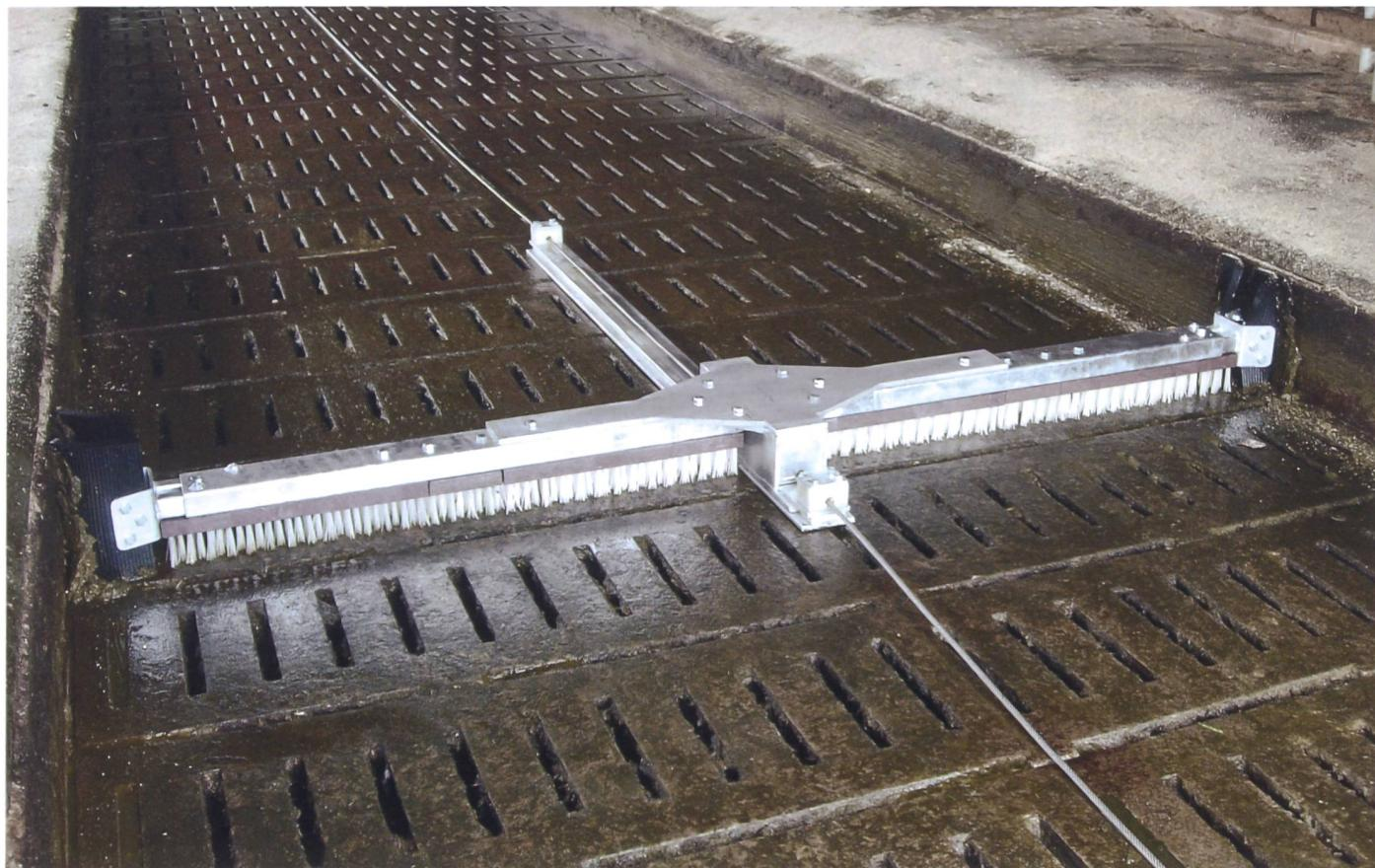
Die beweglichen Bürsten erzeugen einen Reinigungseffekt, der qualitativ über demjenigen eines Gummiabstreifers liegt. (Werkfoto)
