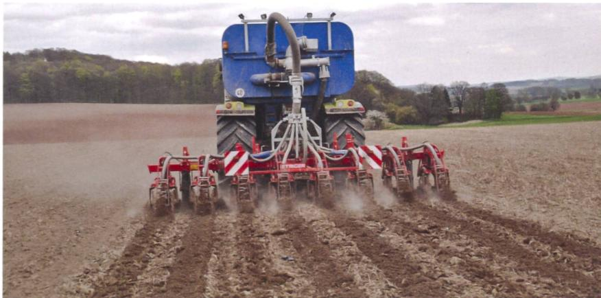
Die Kombination Streifenbearbeitung mit einer Güllegabe steigert die Effizienz des «Striger» (Kuhn) beim Strip-Till-Verfahren.
