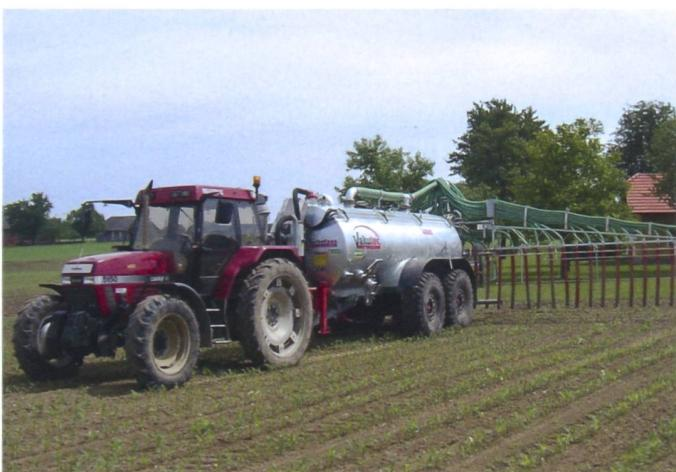
Stahlfässer sind feuerverzinkt und zum Teil noch mit einer KTL-Beschichtung gegen Korrosion geschützt.
