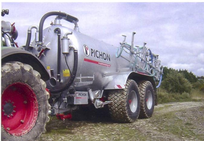
Tandemaggregate zählen zur Standardausrüstung bei Fassgrössen von 8000 bis 18000 Liter.
