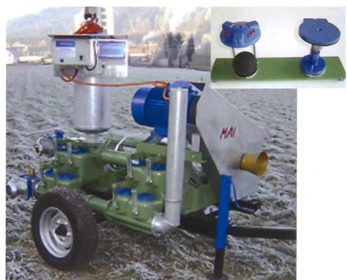
Die Walter Mai AG Huttwil stellt zurzeit keine neuen Pumpen her. Sie hat aber einen Aufrüstsatz im Angebot, mit dem alte Lanz-Pumpen mit moderner Technik aufgerüstet werden können. Speziell zu erwähnen sind hier die Kugel- und Stöpselventile (kleines Bild), die den Querschnitt ganz freigeben und deshalb verstopfungs-frei und mit geringem Hub (höhere Drehzahl möglich) arbeiten.
