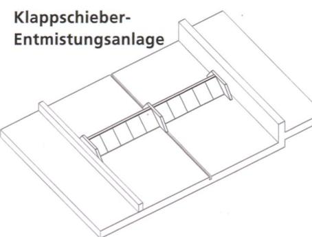
Ein Klappschieber nimmt den Mist mit den senkrecht- oder schräggestellten Pendelklappen mit. Bei der Rückwärtsfahrt werden diese Schieber von der Lauffläche abgehoben. Die kompakte Bauweise ermöglicht ein Räumen von Beginn an, ein «Warteraum» oder ein «Öffnungsweg» ist nicht notwendig. Er
