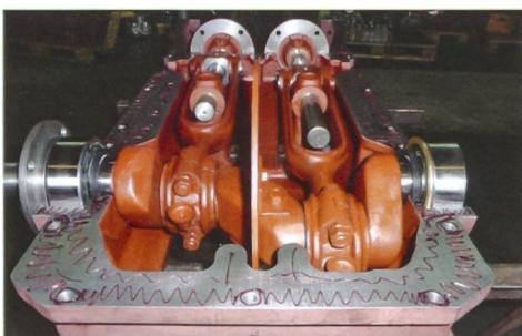
Alle heute hergestellten Kolbenpumpen sind mit einem im Ölbad geschlossenen Kurbelgehäuse ausgestattet. Somit ist der Antrieb mit Ausnahme des Ölwechsels weitgehend wartungsfrei.
