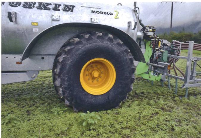
Bei wechselnder Verteiltechnik ist eine verschiebbare Achse notwendig, damit die Stützlast auf den Traktor optimiert werden kann.
