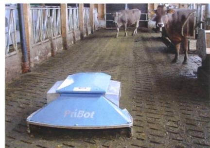
Die Firma Prinzing in Lonsee (D) hat mit dem «PriBot» einen Roboter mit Bewegungssteuerung mittels Kantensor und Ultraschall im Programm.
