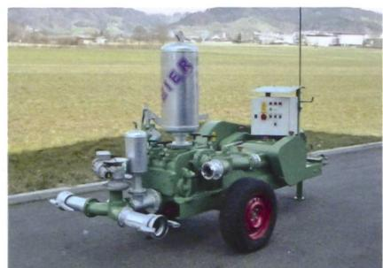
Ein Rahmen aus U-Schienen gibt dieser Pumpe ihre Stabilität und ermöglicht es, dass mit geringem Aufwand ein Fahrwerk für den überbetrieblichen Einsatz angebaut werden kann.
