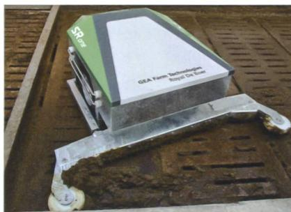
Der Spaltenroboter von GEA Farm Technologies Suisse AG in Ittigen wird durch Drucksensoren am Schieber geführt.
