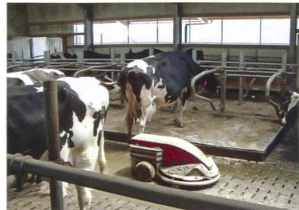
Durch Ultraschallsensoren und einen Tastring wird der Lely-Discovery bei Wendemanövern gesteuert.
