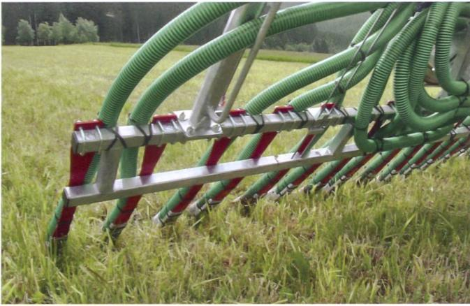
Durch Federkraft wird sichergestellt, dass der Schleppschuh auch die Gülle wirklich auf der Erde ablegt. (Foto: Ruedi Hunger)
