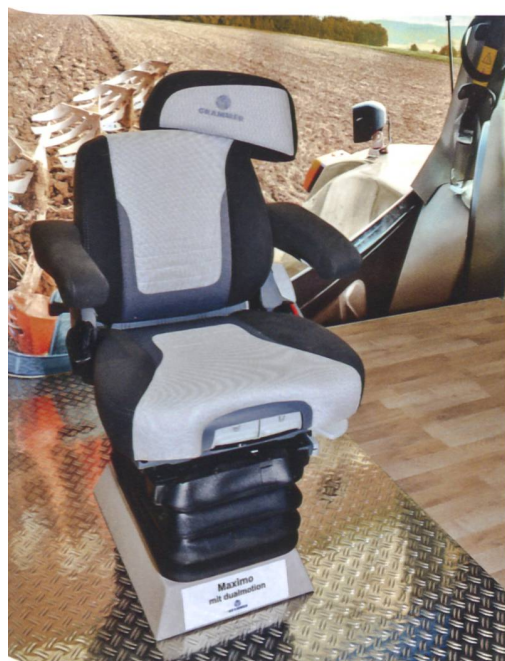
Die verschiebbare Kopfstütze von Grammer erleichtert das Rückwärtsschauen und erhöht die Ergonomie.
