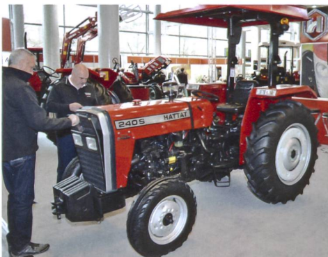
Gewisse Traktoren werden nur mit Sturzbügel angeboten, was einen Einsatz mit Frontlader oder Seilwinde erschwert, weil der Fahrer nicht ausreichend geschützt wird.
