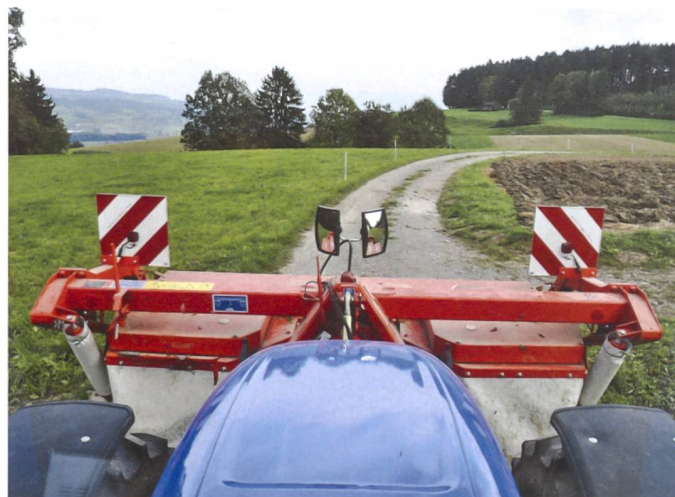
Mehr als 3 m vorderer Überhang: Seitenblickspiegel vergrössern das Blickfeld nach links und rechts.
