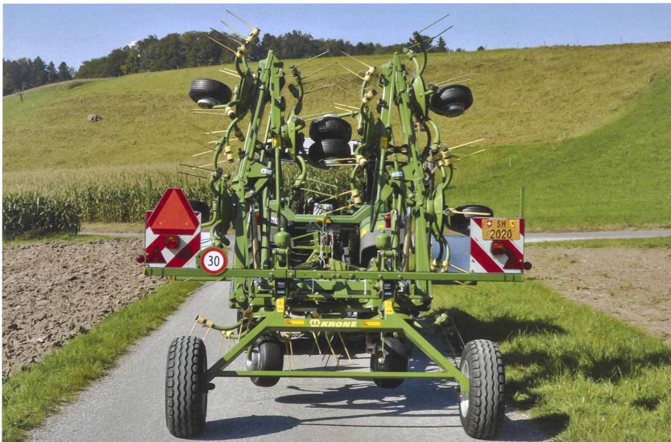
Vorbildlich – alle Sicherheitselemente sind montiert, um den überbreiten Arbeitsanhänger und die tiefe Fahrgeschwindigkeit zu signalisieren. (Bilder: BUL)
