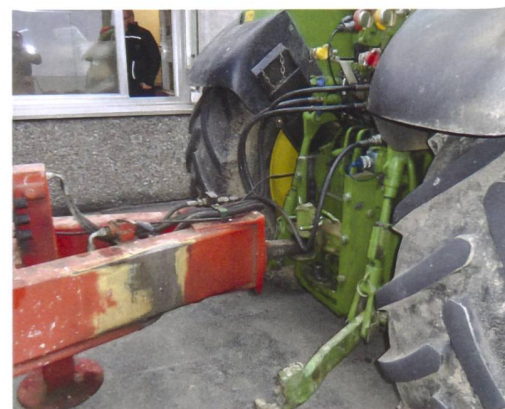
Anhängervorrichtungen, die höhenverstellbar im Zugschlitten montiert sind, haben meist eine tiefere Stützlast als fest eingebaute oder verschraubte Varianten.
