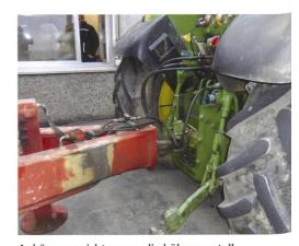
Anhängevorrichtungen, die höhenverstellbar im Zugschlitten montiert sind, haben meist eine tiefere Stützlast als fest eingebaute oder verschraubte Varianten.
