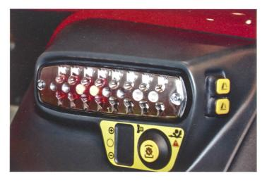
Immer mehr Fahrzeuge und Anhänger werden mit LED-Lichtern ausgestattet.
