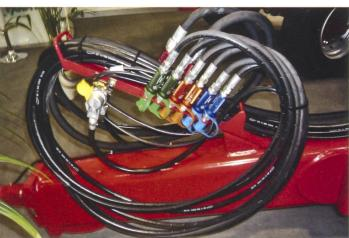
Farbige Hydraulikanschlüsse verhindern eine Verwechslungsgefahr der Anschlüsse.
