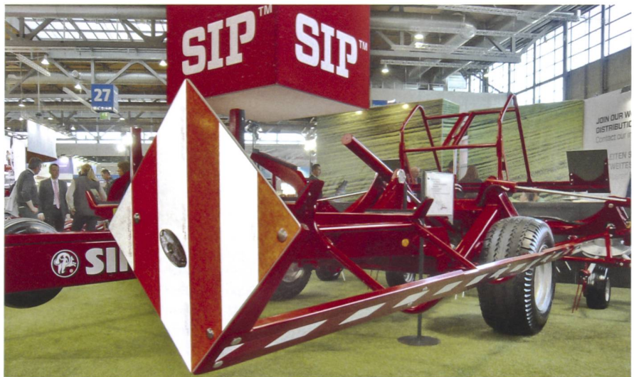
Bei diesem Kreiselheuer ist die Strassenverkehrssicherheit nach dem Zusammenklappen gewährleistet.
