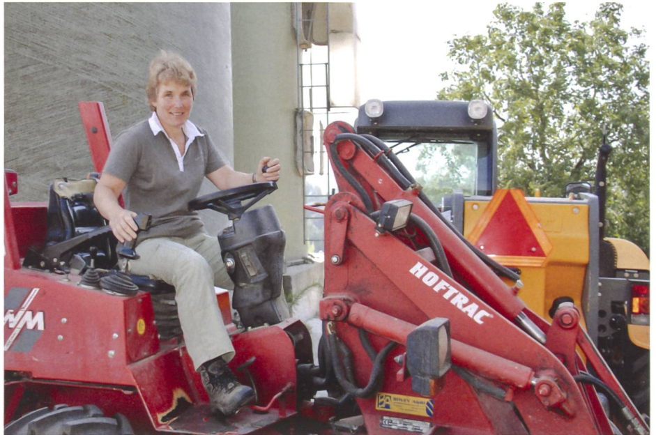
Die Sitzhaltung Edith Kaenels auf dem Hoftrac ist unergonomisch; eine Sitzverstellung nach vorne wäre hilfreich, damit sie die Pedale korrekt bedienen kann.
