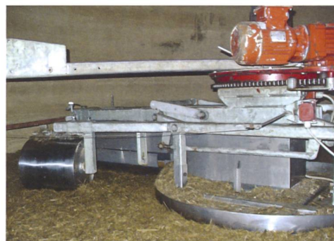
Silofräsen verteuern zwar Hochsiloanlagen erheblich. Gesundheit und Arbeitskomfort aber sind gewichtige Argumente, die dafür sprechen.
