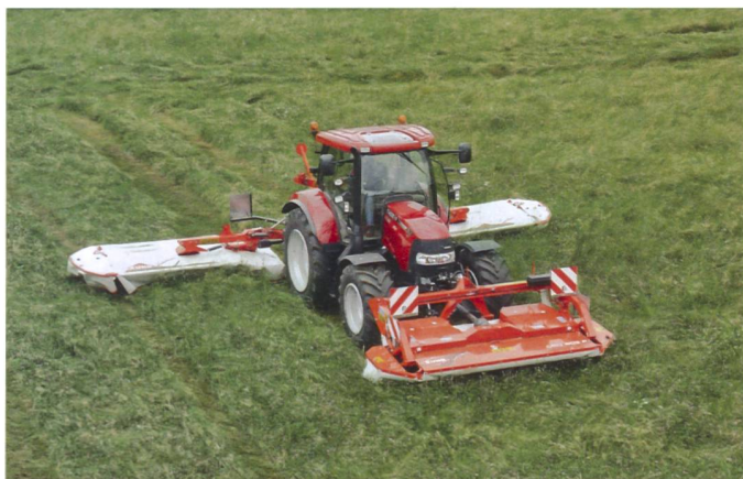
Rotationsmäherwerke erzielen, mit einer Klingenhöhe von sechs Zentimetern, Stoppellängen von sieben bis acht Zentimetern. (Werkbilder)
