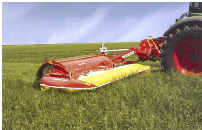
Aufbereiter sollen die Wachsschicht, die der Pflanze als Verdunstungsschutz dient, zerstören, aber die Pflanzen nicht zerkleinern.
