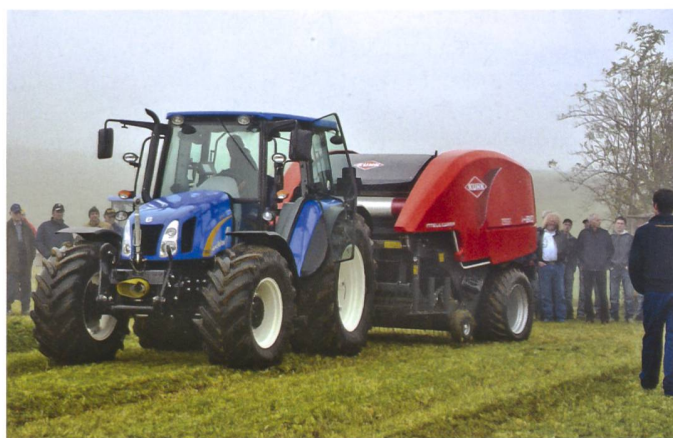
Ein zu tief laufender Pick-up verschmutzt das Futter. Fehlgärungen und Qualitätseinbussen sind die Folge.
