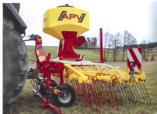
Striegel durchlüften und entfilzen die Grasnarbe, zudem schaffen sie für Gräser den Anreiz zur Bestockung.
