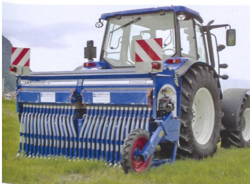
Über- oder Einsaaten erfolgen mit dem «Herbamat» direkt in die Grasnarbe.
