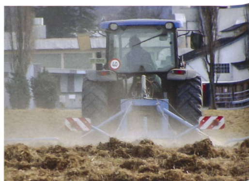
Grosse Strohmen gen drehen sich unter der Wiesenegge und bleiben als eingedrehte «Würste» auf dem Feld zurück.
