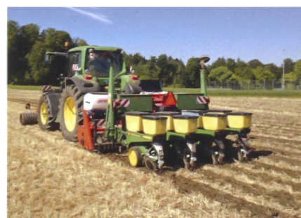
Die Streifenfräse OekoSem-4 von Althaus ist AP14-17 konform.
