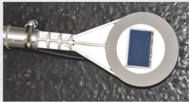
Das von Meteotest an den Stationen verwendete Blattnässe-Messgerät misst nach dem Prinzip der Leitfähigkeit.
