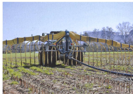
Wird Gülle durch den Schlauch «geschickt», fallen Überfahrten mit dem Fass weg, und die Bodenbelastung reduziert sich wesentlich.
