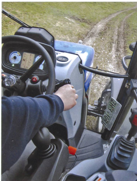
Der Joystick kann beim Betätigen des Blinkers stören.
