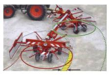
Der R+1410 SB von JF ist der einzige Wurmschwader mit einer automatischen Bogenlenkung. Das hintere Fahrwerk folgt versetzt spurtreu dem vorderen, sodass der Fahrer in Kurven nicht manuell lenken muss.
