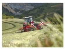
Kuhn bietet Wurmschwader in vier Arbeitsbreiten von 5,4 bis 8,8 m an. Mit Wurmschwadern wie diesem kann der hintere Kreisel dank Lenkung der Hangneigung entgegensteuern.
