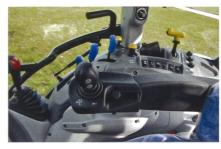
Auf der Armlehne können der Joystick und dessen elektronische Mengensteuerung bedient werden.
