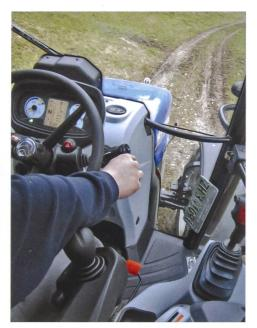
Der Joystick kann beim Betätigen des Blinkers stören.
