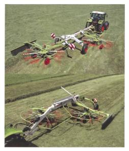
Claas bietet neben dem herkömmlichen Seitenschwader (unten) mit dem Liner 1250 auch eine Version an, bei der die Transportachse zwischen den beiden Kreiseln angeordnet ist. Bei dieser günstigeren Bauweise liegt der Schwerpunkt tiefer.
