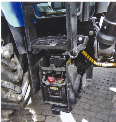
Die Batterie befindet sich unter den rechten Stufen und ist sehr gut zugänglich.
