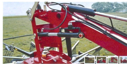
Für die Verstellung von Schwad- und Arbeitsbreite setzt Fella statt auf Teleskoparme auf ein zusätzliches Gelenk. Die Kreisel sind auch bei dieser Bauweise kardanisch aufgehängt.
