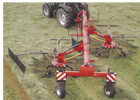
Bei diesem Seitenschwader von Vicon wird durch Hundeganglenkung von Einfach- auf Zweischwadablage umgestellt, was eine etwas günstigere Bauweise ist als mit hydraulischen Teleskoparmen.
