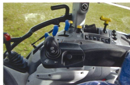
Auf der Armlehne können der Joystick und dessen elektronische Mengensteuerung bedient werden.
