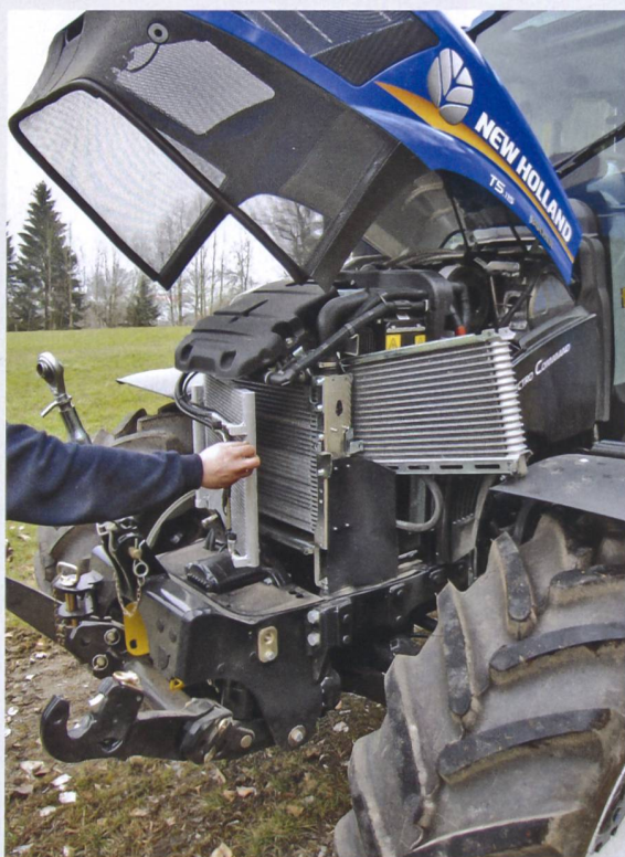
Der vorderste Kühler lässt sich wegklappen, der Ölkühler sogar ganz aus dem Paket herausziehen.
