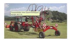
SIP bietet Mittelschwader an, mit denen in engen Passagen dank einem Y-Antrieb auch mit nur einem abgesenkten Kreisel gearbeitet werden kann.
