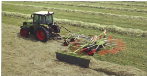
Der Liner 550 T von Claas ist mit 5,5 m Arbeitsbreite der grösste Einkreiselschwader. Er hat ein 4-Rad-Fahrwerk plus zwei Tasträder vor dem Kreisel.
