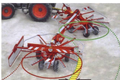
Der R+1410 SB von JF ist der einzige Wurmchwader mit einer automatischen Bogenlenkung. Das hintere Fahrwerk folgt versetzt spurtreu dem vorderen, sodass der Fahrer in Kurven nicht manuell lenken muss.
