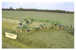
Krone bietet zurzeit als einziger Hersteller auch einen Seitenschwader mit drei Kreiseln und sogar einen Mittelschwader mit sechs Kreiseln an.
