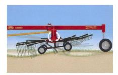
Terra Link von Kverneland ist ein Bodenanpassungssystem, bei welchem der Kreisel in Fahrtrichtung und quer zur Fahrtrichtung frei bewegt und durch die Tasträder geführt werden kann.
