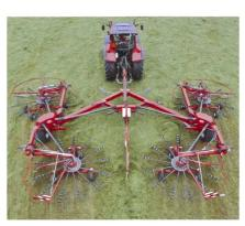
Der Hibiscus 1515 CD Profi ist mit einem V-Rahmen-Konzept gebaut, bei dem die Transporträder zum arbeiten mit den Kreiseln nach aussen geschwenk werden.
