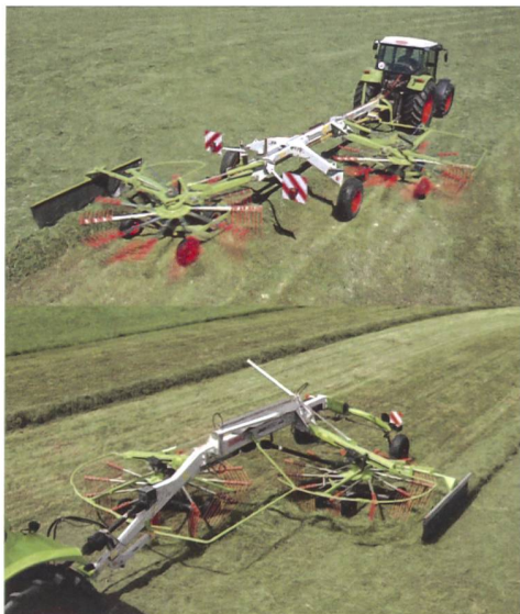
Claas bietet neben dem herkömmlichen Seitenschwader (unten) mit dem Liner 1250 auch eine Version an, bei der die Transportachse zwischen den beiden Kreisel angeordnet ist. Bei dieser günstigeren Bauweise liegt der Schwerpunkt tiefer.
