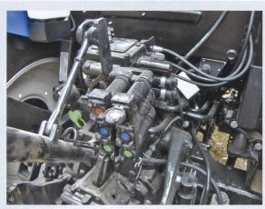
Alle drei Steuergeräte am Heck sind mit einer manuellen Mengeneinstellung ausgestattet.
