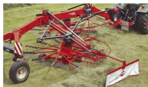
Die Trägerarme dieses Seitenschwaders von Kuhn sind mit hydraulischer Teleskopierung ausgestattet, mit der die Schwadablage und in einem gewissen Rahmen auch die Arbeitsbreite verstellt werden können.
