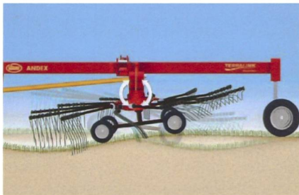
Terra Link von Kverneland ist ein Bodenangepassungssystem, bei welchem der Kreisel in Fahrtrichtung und quer zur Fahrtrichtung frei bewegt und durch die Tasträder geführt werden kann.
