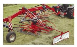
Die Trägerarme dieses Seitenschwaders von Kuhn sind mit hydraulischer Teleskopierung ausgestattet, mit der die Schwadablage und in einem gewissen Rahmen auch die Arbeitsbreite verstellt werden können.
