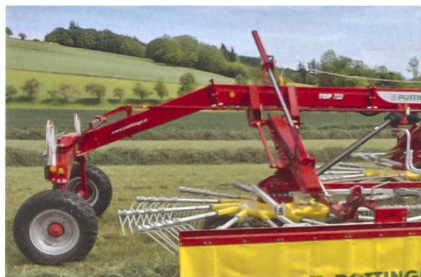
Ein exzentrischer Lenkstangendrehpunkt sorgt bei diesem Pöttinger-Schwader dafür, dass der Kreiselarm beim Ausheben automatisch verkürzt und so die Transporthöhe reduziert wird.
