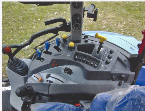
Die Laststufen werden über die orangenen Knöpfe in der Mitte der Seitenkonsole bedient, leider aber nicht auf der Armlehne.
