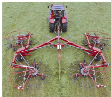
Der Hibiscus 1515 CD Profi ist mit einem V-Rahmen-Konzept gebaut, bei dem die Transporträder zum arbeiten mit den Kreiseln nach aussen geschwenkt werden.
