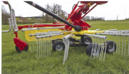
Das nachlaufgelenkte Tastrad ausserhalb des Kreisels bieten viele Hersteller wie Pöttinger als Zusatzausrüstung für unebenes Gelände an.
