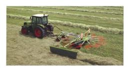
Der Liner 550 T von Claas ist mit 5,5 m Arbeitsbreite der grösste Einkreiselschwader. Er hat ein 4-Rad-Fahrwerk plus zwei Tasträder vor dem Kreisel.
