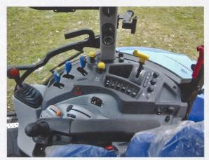
Die Lastschaltstufen werden über die orangen Knöpfe in der Mitte der Seitenkonsole bedient, leider aber nicht auf der Armlehne
