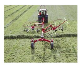
Der 1065 Pro von Fella verstellt beim Ausheben automatisch die Kurvenbahn, wodurch eine höhere Bodenfreiheit erzielt werden kann.
