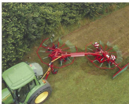
Der Wurmchwader von Kverneland lässt sich dank «SideShift» seitlich schwenken, sodass er auch unter Bäumen arbeiten kann, oder auf die andere Seite, sodass der Traktor nicht über das Futter fahren muss.
