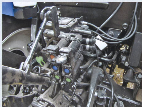
Alle drei Steuergeräte am Heck sind mit einer manuellen Mengeneinstellung ausgestattet.
