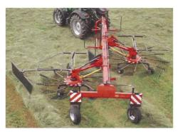
Bei diesem Seitenschwader von Vicon wird durch Hundeganglenkung von Einfach- auf Zweischwadablage umgestellt, was eine etwas günstigere Bauweise ist als mit hydraulischen Teleskoparmen.
