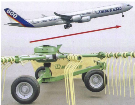
Einige Hersteller wie hier Krone preisen den Jet-Effekt an: Beim Absenken und Ausheben der Kreisel bleiben die hinteren Räder länger am Boden, so wird ein Einstechen der Zinken verhindert.
