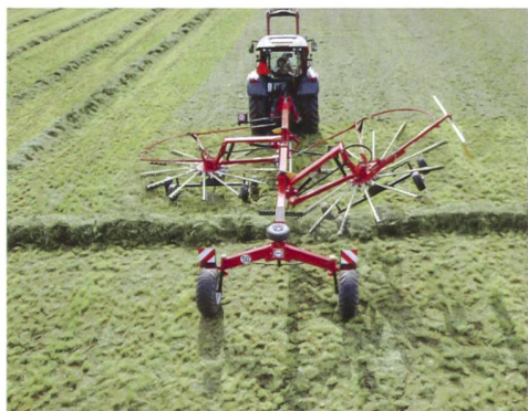
Der 1065 Pro von Fella verstellt beim Ausheben automatisch die Kurvenbahn, wodurch eine höhere Bodenfreiheit erzielt werden kann.
