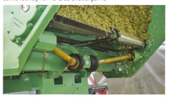
Die Transportböden der Silagewagen Silo-SPACE werden über eine Kardanwelle und das Verteilergetriebe mechanisch angetrieben.
