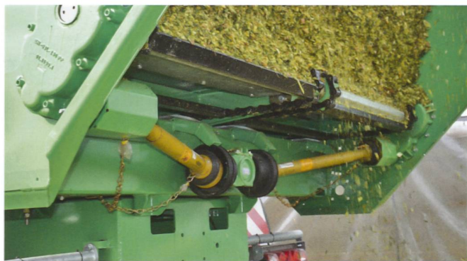
Die Transportböden der Silagewagen Silo-SPACE werden über eine Kardanwelle und das Verteilergetriebe mechanisch angetrieben. (Werkbild)
