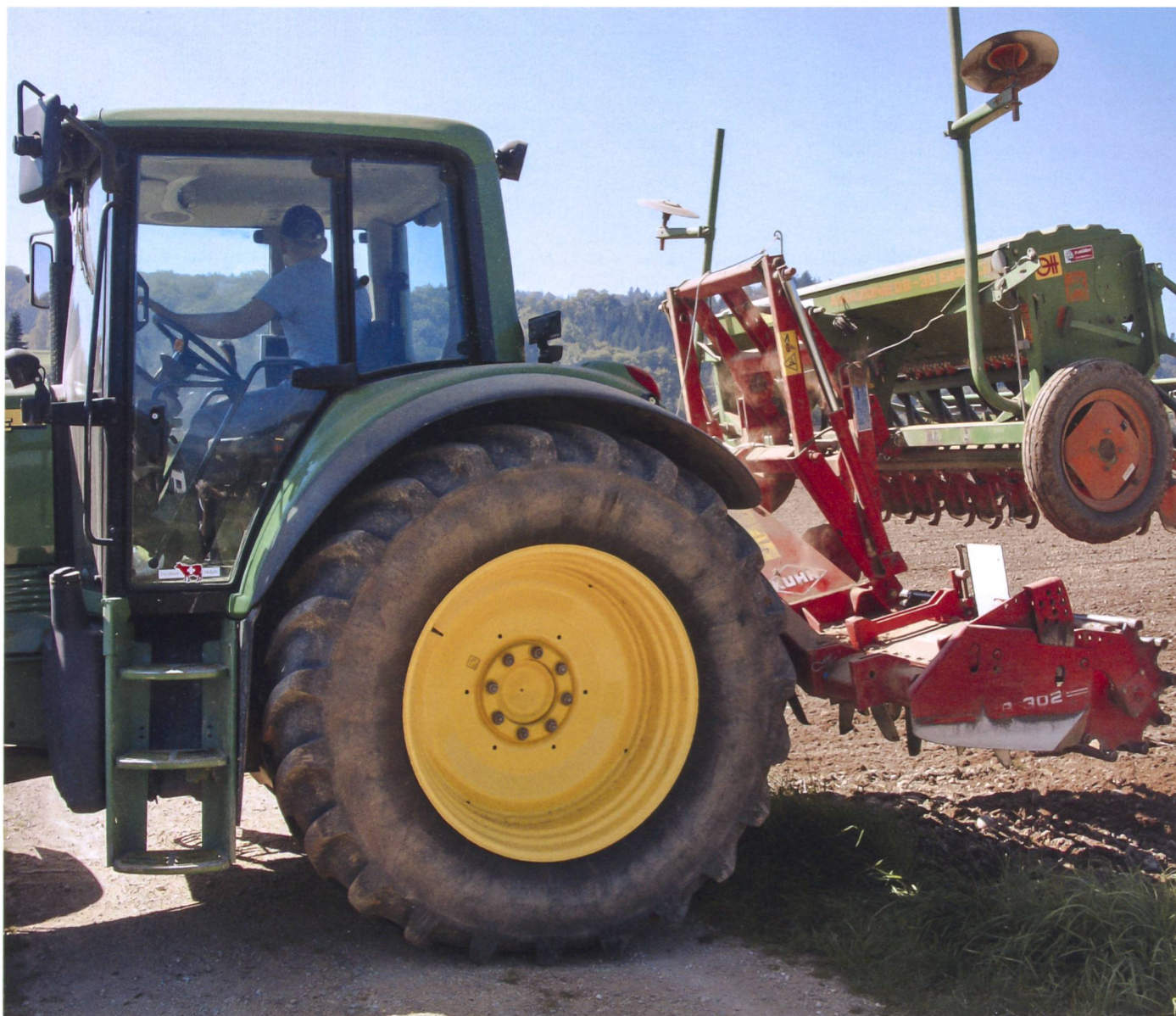
Die Achsentragfähigkeit garantiert der Hersteller mit dem Garantiegewicht. Die Achslast von 11,5 Tonnen aber ist die gesetzliche Höchstlimite für eine angetriebene Achse. (Bilder: Ueli Zweifel)
