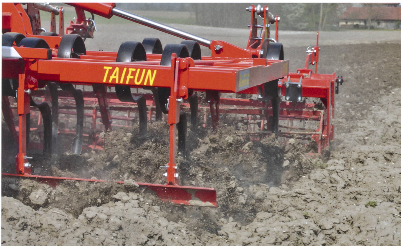
Einebnen, lockern und rückverfestigen – das können Geräte mit passiv arbeitenden Werkzeugen auch bei hoher Flächenleistung.
