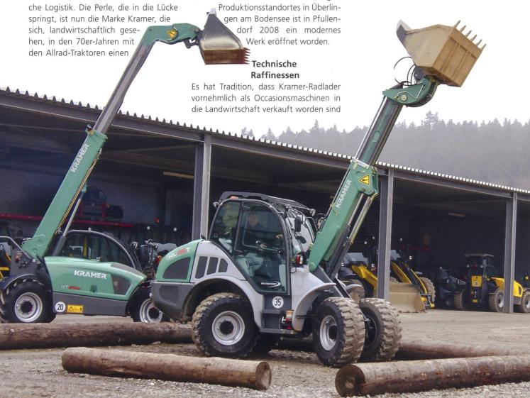
Sondermodelle für die Landwirtschaft: Im Vordergrund der Telelader KL35T mit beeindruckendem Lenkeinschlag. Im Hintergrund der grössere Typ der beiden Teleskopladermodelle (KT256), die unter der Marke Kramer verkauft werden. Die grösseren Modelle gehören exklusiv ins Portfolio von Claas. (Bilder: Ueli Zweifel)
