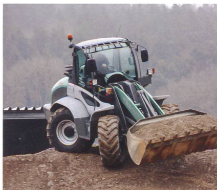
Herkules in schwieriger Lage. Die Rahmenbauweise aber bewirkt eine hohe Stabilität und der heckseitige Motor schraubt die Kipplast nach oben.
