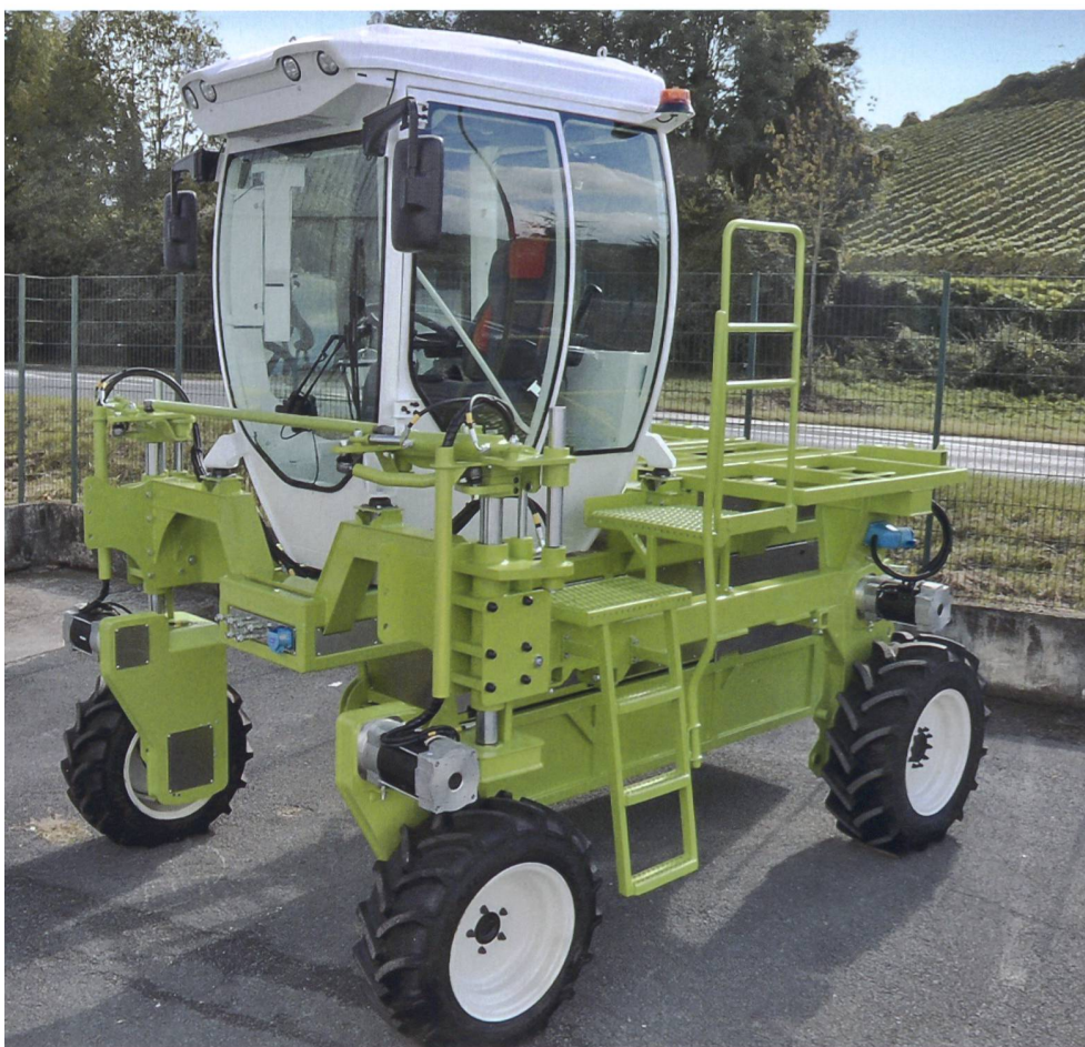
Der elektrische Stelzen-Geräteträger (Keimer) macht ersichtlich, dass der elektrische Antrieb in der Mechanisierung auch für eine grössere Leistung ein Thema sein kann. (Bild: Pressedienst)
