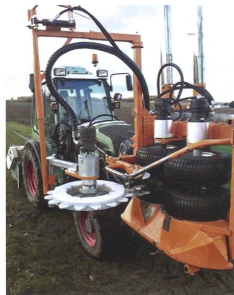
Die Maschine zum Ziehen der Rebhölzer (PROVITIS) lehnt sich an die manuelle Ausführung dieser Arbeit an. Findet das einfache Konzept bei den Winzern Anklang? (Bild: Pressedienst)
