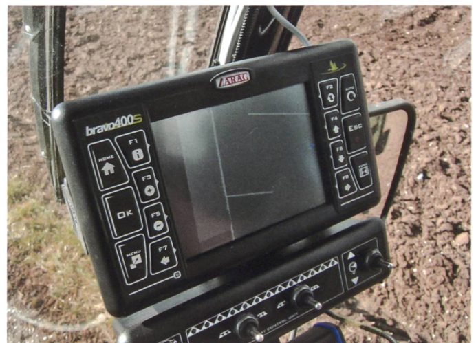
Auf dem Computer lässt sich nach dem Spritzen auf der Feldkarte genau rückverfolgen, wo welche Düsen geöffnet waren.
