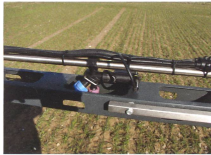
Jeder Abgang ist mit einem Magnetventil und einem Dreifach-Düsenträger ausgestattet.
