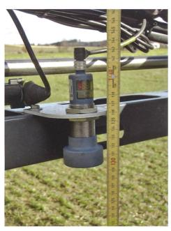
Mit zwei solchen Radarmessgeräten wird die Höhe des Spritzbalkens überwacht.
