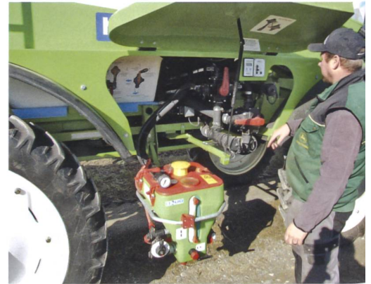
Die komfortable Fülltechnik mit Einspülschleuse spart dem Fahrer Zeit.
