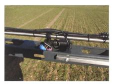
Jeder Abgang ist mit einem Magnetventil und einem Dreifach-Düsenträger ausgestat-
