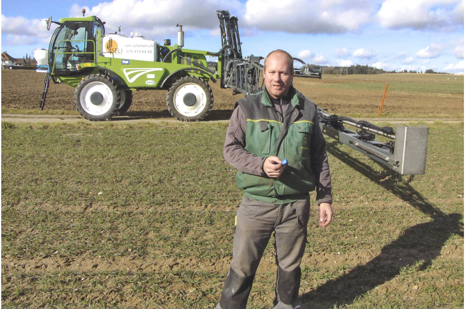
Mit einem Streuer vor der Kabine kann Stefan Iseli beim Spritzen zusätzlich Schneckenkörner ausbringen. (Bilder: Ruedi Burkhalter)
