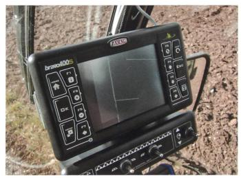
Auf dem Computer lässt sich nach dem Spritzen auf der Feldkarte genau rückverfolgen, wo welche Düsen geöffnet waren.
