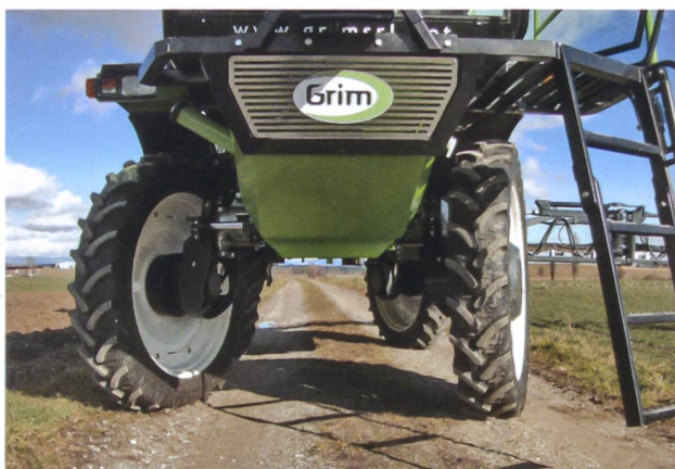
Spezialfahrzeug mit spurtreuer Lenkung, hydraulischem Antrieb und Breitenverstellung
