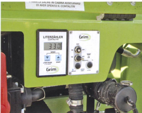
Beim Füllen (unten) und während der Arbeit sieht der Fahrer immer, wie viele Liter sich im Brühetank befinden.
