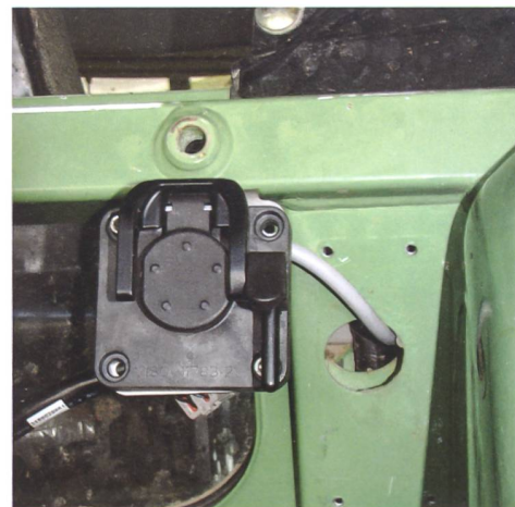
Von der Isobus-Steckdose konnte das Kabel direkt in den Rahmen verlegt werden.
