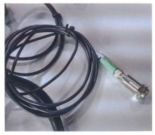
Falls nötig, wird ein solcher Drehzahlsensor zur Messung der Fahrgeschwindigkeit an der Welle des Allradantribs montiert.
