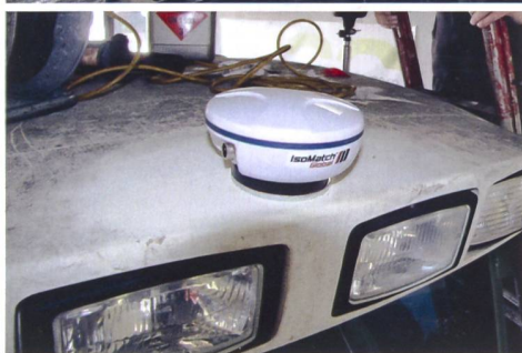
Der Magnethalter des GPS-Empfängers wird nach dem Kleben erhitzt.
