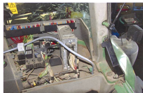
Zwischen der bestehenden Elektronik hat es genug Platz für eine geschützte Kabelführung.
