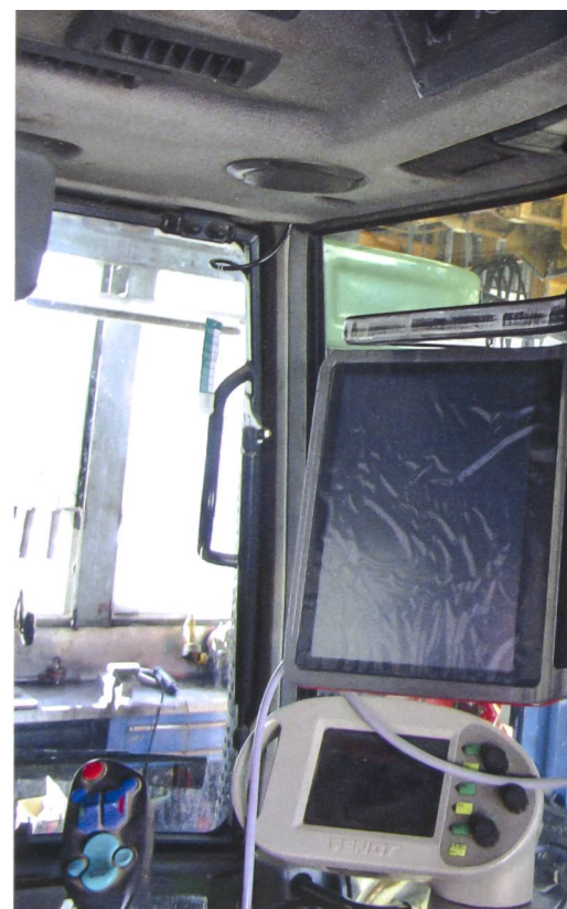
In der Arbeitsposition verdeckt das Terminal die Sicht auf den rechten Rückspiegel.
