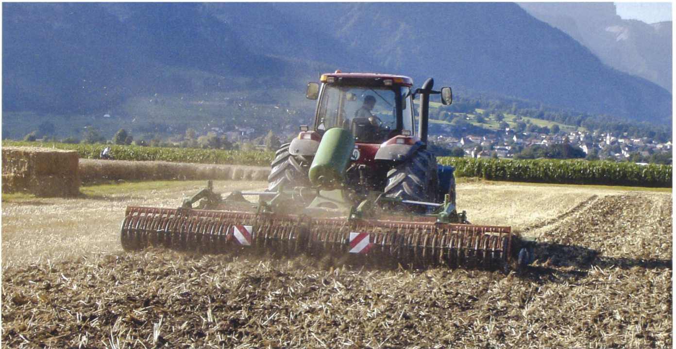
Auch mit einer Kurzscheibenegge ist für eine «beendete» Stoppelbearbeitung ein zweiter Durchgang notwendig. (Bild: Ruedi Hunger)
