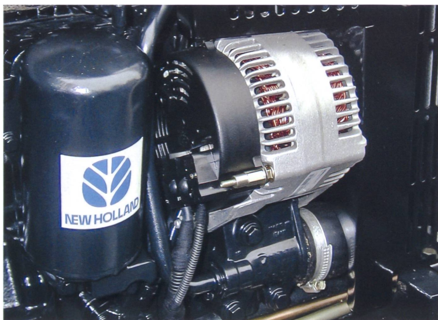
Alternatoren bei grösseren Traktoren haben heute eine Leistung, welche einen Elektromotorbetrieb bis 1 kW Leistungsaufnahme über die Bordelektrik kurzzeitig zulässt.
