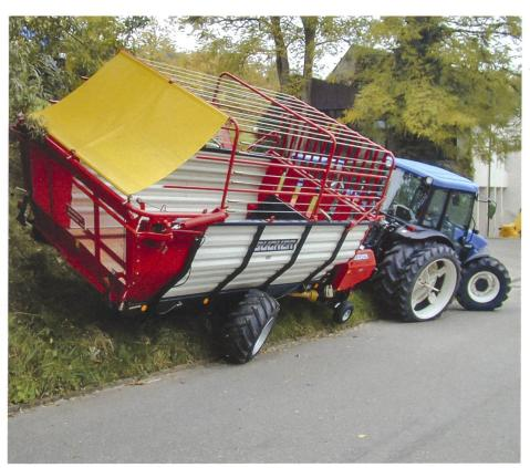
Lenkachsen bei kleineren Anhängern werden rein mechanisch (Gestänge) oder hydraulisch (Geber- und Nehmerzylinder) gesteuert. Bei grossen Anhängern ist dies nicht mehr sinnvoll, da die Kräfte zu gross sind. Hier werden Lenksysteme mit Fremdkraftunterstützung (oft elektrohydraulisch geschaltet mit Öldruck durch die Traktorhydraulik) eingesetzt.
