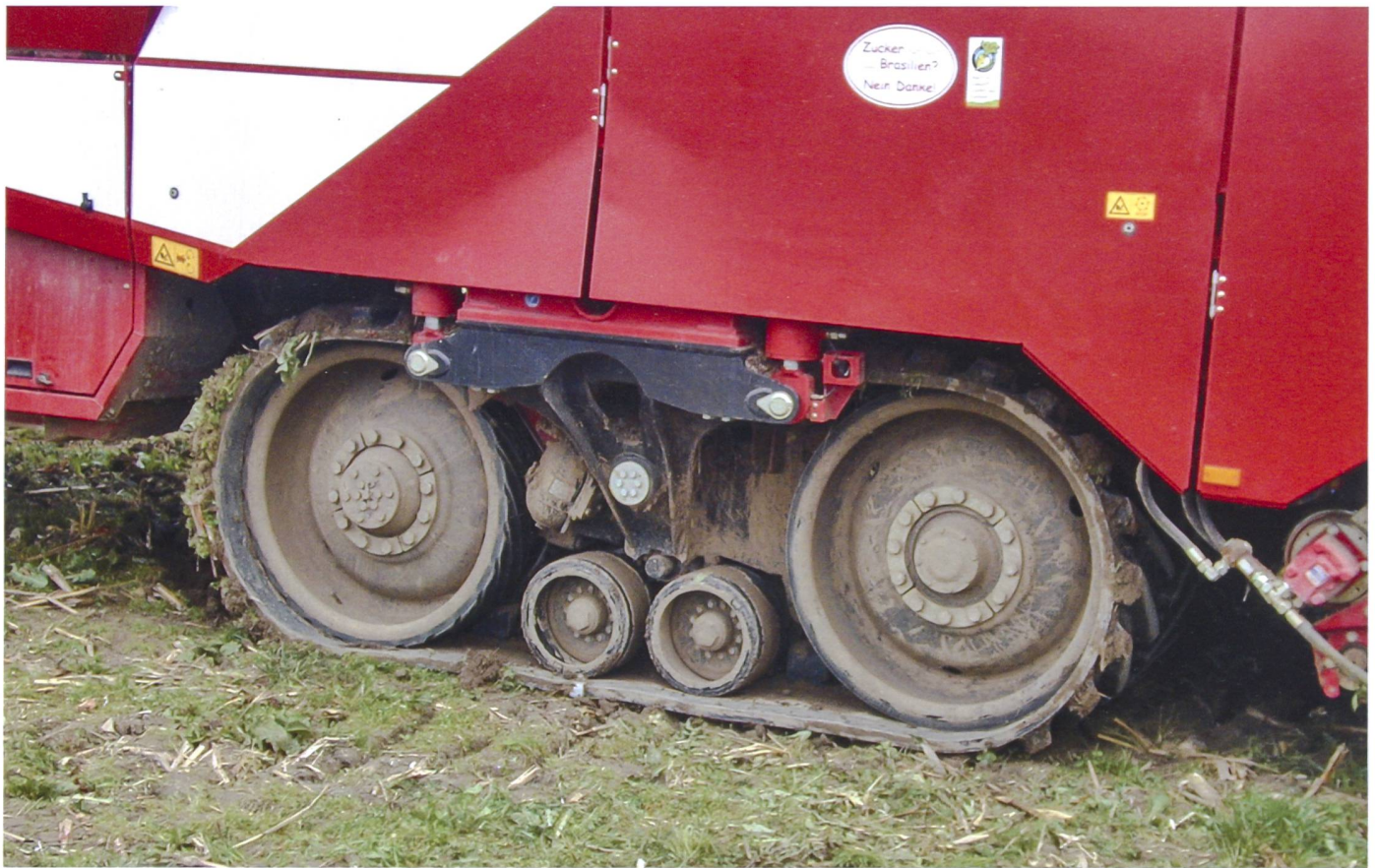
Hydraulische Fahrantriebe mit Radnabenmotoren sind heute bei vielen Baumaschinen und Erntemaschinen Stand der Technik. Werden sie in Zukunft durch elektrische Antriebe mit besserem Wirkungsgrad ersetzt? (Bilder: Ruedi Gnädinger)
