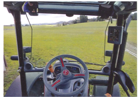
Helle Kabine mit guter Rundumsicht: Das Abgasrohr wird rechts am Holm hochgeführt, und es gibt keinen Partikelfilter, der die Sicht behindert.
