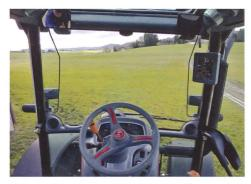
Helle Kabine mit guter Rundumsicht: Das Abgasrohr wird rechts am Holm hochgeführt, und es gibt keinen Partikelfilter, der die Sicht behindert.
