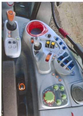
Übersichtliche Bedienkonsole dank unterschiedlicher Farbgebung für Steuergeräte, Heckkraftheber, Zapfwelle und Motor/Getriebe/Parkbremse.
