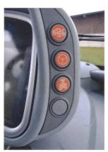
Über drei Schaltknöpfe am Armaturenbrett können die Funktionen Streckbremse, SDD-Lenksystem und Vorderachsfederung gewählt werden.
