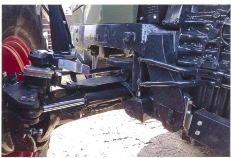
SDF-eigene Vorderachse mit optionaler hydraulischer Federung.
