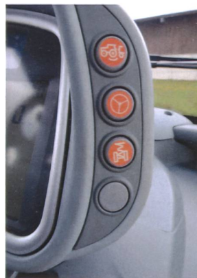
Über drei Schaltknöpfe am Armaturenbrett können die Funktionen Streckbremse, SDD-Lenkensystem und Vorderachsfederung gewählt werden.
