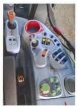
Übersichtliche Bedienkonsole dank unterschiedlicher Farbgebung für Steuergeräte, Heckkraftheber, Zapfwelle und Motor/ Getriebe/Parkbremse.
