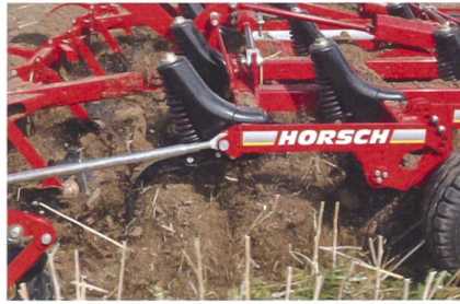
Hier zeigt der Terrano von Horsch seine Stärke bezüglich intensiver Bodendurchmischung.
