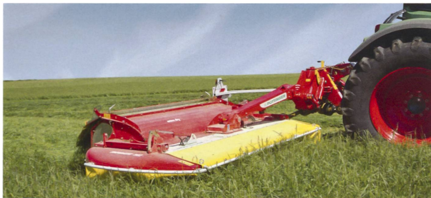
Der Novacat 302 ED von Pöttinger besitzt eine hydraulische Unterlenkerwippe. (Werkbild)
