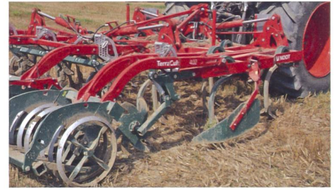
Strohleitbleche und Fächerscheiben sorgen bei VN-TerraCult dafür, dass alles (Stroh) in geordneten Bahnen verläuft und eingebettet wird.
