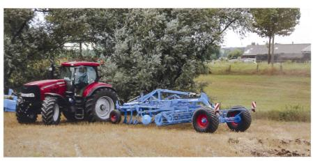
Eine Transportachse hinter dem Arbeitsfeld entschärft bei Lemken das Ausheben der vier und fünf Meter breiten dreibalkigen Karat-Grubber.
