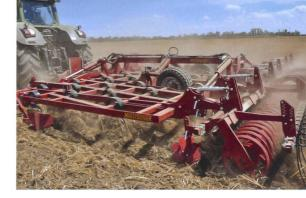
Der Grossflächengrubber von Einböck ist ein Bindeglied zwischen der Federzinkenegge und dem 4-balkigen Universalgrubber.
