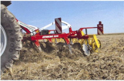
Der 2-balkige Synkro von Pöttinger besitzt mit 80 cm Durchgang und einem Balkenabstand von 75 cm genügend Durchlass für viel organische Masse.
