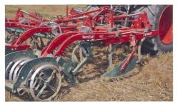
Strohleitbleche und Fächerscheiben sorgen bei VN-TerraCult dafür, dass alles (Stroh) in geordneten Bahnen verläuft und eingeebnet wird.
