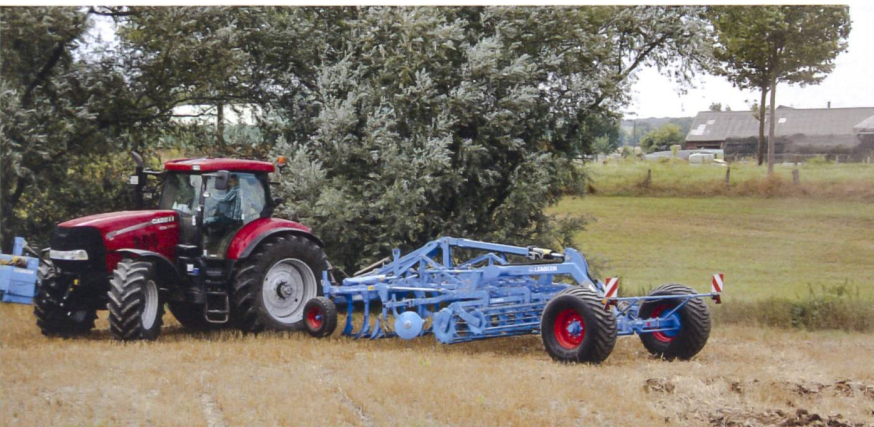
Eine Transportachse hinter dem Arbeitsfeld entschärft bei Lemken das Ausheben der vier und fünf Meter breiten dreibalkigen Karat-Grubber.
