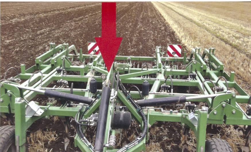
Beim Komet KAS von Kerner erfolgt die automatische Anpassung an Bodenkonturen mit einem sensorgesteuerten Deichselzylinder.
