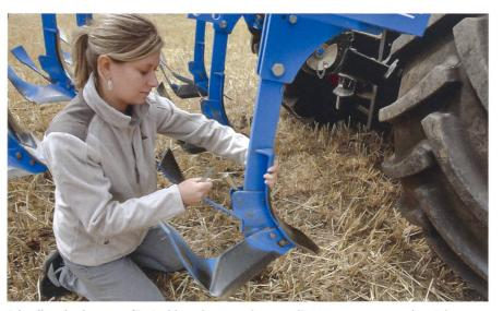
Schnellwechselsysteme für Grubberscharen verbessern die Voraussetzungen, dass Scharen den Bedürfnissen entsprechend gewechselt werden.
