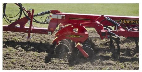
Das vorlaufende Scheibenpaket kann beim TopDown von Väderstad je nach Bedarf angehoben oder abgesenkt werden.
