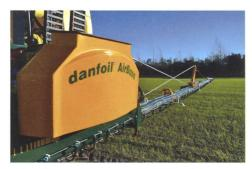
Beim Düsensystem von Danfoil dient der Luftstrom zum Transport des Spritznebels in den Pflanzenbestand.
