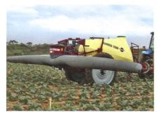
Beim bekannten Hardy Twin System wird der Spritznebel in den Bestand gepustet.
