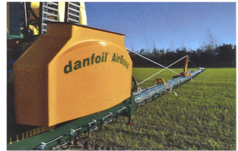
Beim Düsensystem von Danfoil dient der Luftstrom zum Transport des Spritznebels in den Pflanzenbestand.
