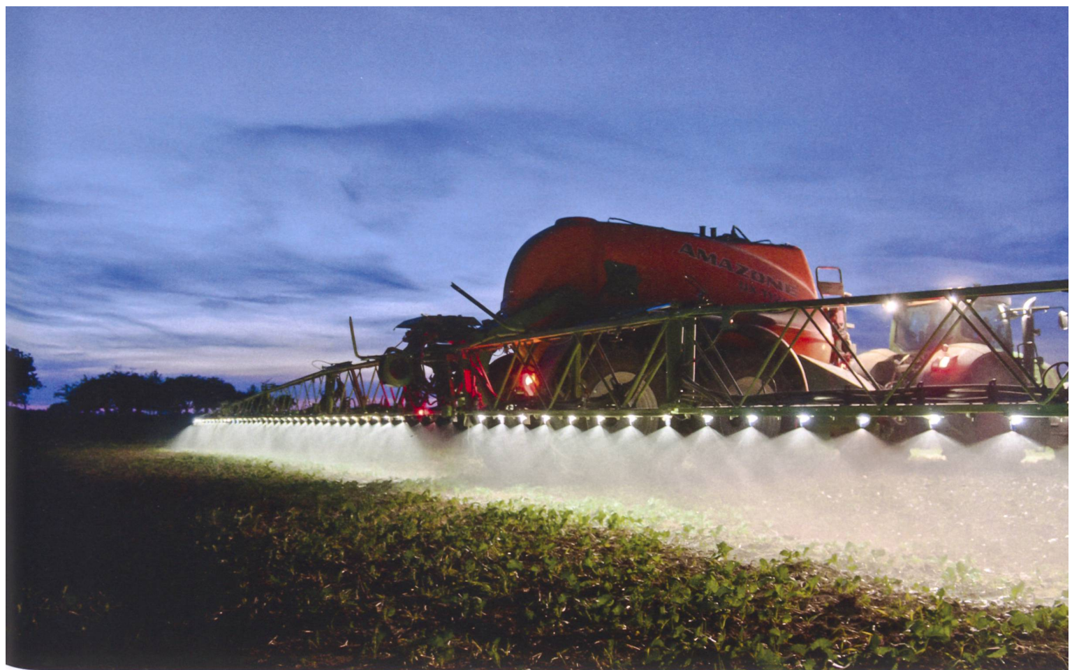
Mit einer LED-Düsenbeleuchtung lässt sich auch nachts die Funktion jeder einzelnen Düse sehr gut optisch kontrollieren. (Bilder Werkfotos)
