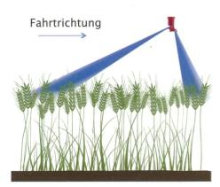
Die AI-3070-Injektor-Doppelflachstrahldüse ist speziell für die Ährenbehandlung geeignet. Sie vereint die Vorteile der Injektordüse mit einer guten beidseitigen Wirkstoffanlagerung.
