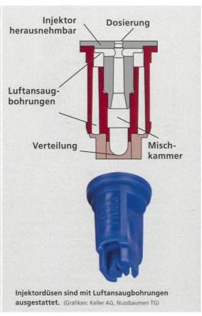
Injektordüsen entwickelt worden. Unten abgebildet ist eine Al3070-Injektor-Doppelflachstrahldüse von Teejet, eine Neuentwicklung speziell zur Ährenbehandlung. Sie ist mit einem Splitter ausgerüstet, der in einem Flachstrahlverteiler 30 Grad nach vorne und einem zweiten 70 Grad nach hinten mündet.
