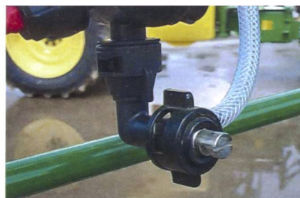
Bei der TwinFluid-Düse von John Deere lässt sich mit der Steuerung vom Verhältnis Flüssigkeitsdruck zu Luftdruck die gewünschte Tröpfchengrösse erzeugen.
