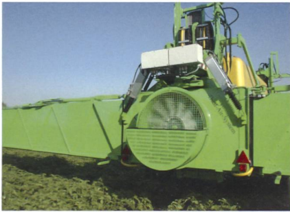
Beim Dual Air System von Dammann wird der Spritznebel vorne und hinten von einem Luftstrom abgeschirmt.
