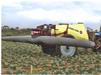
Beim bekannten Hardy Twin System wird der Spritznebel in den Bestand gepustet.
