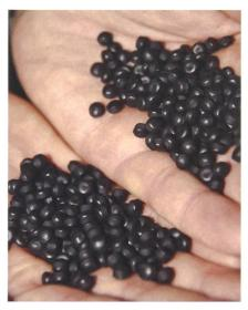
Granulat als Ausgangsmaterial für Rohre, Folien und Profile. (Bild: Ueli Zweifel)
