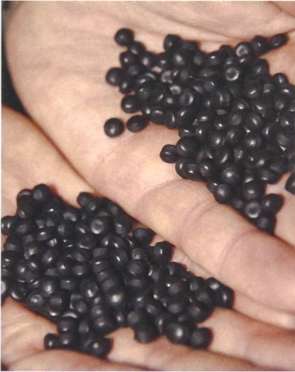
Granulat als Ausgangsmaterial für Rohre, Folien und Profile. (Bild: Ueli Zweifel)
