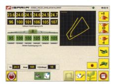
Dieses von Fritzmeier entwickelte sensorgestützte Düsensteuerungssystem ermöglicht den optimalen Einsatz von Pflanzenschutzmittel. (Bild: Fritzmeier Umwelttechnik)
