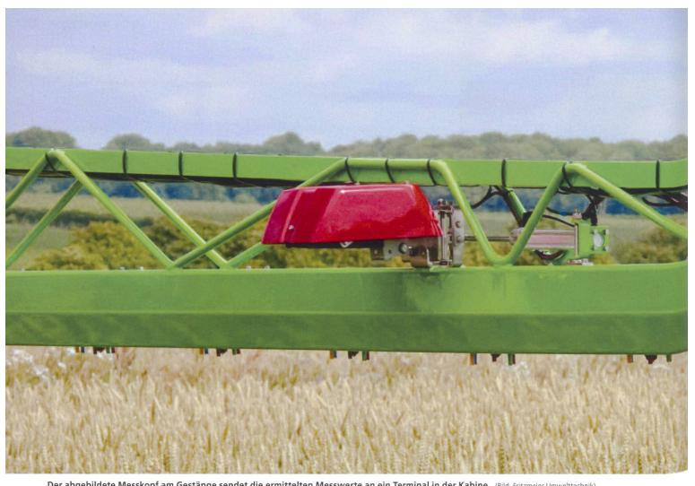
Der abgebildete Messkopf am Gestänge sendet die ermittelten Messwerte an ein Terminal in der Kabine. (Bild: Fritzmeier Umwelttechnik)
