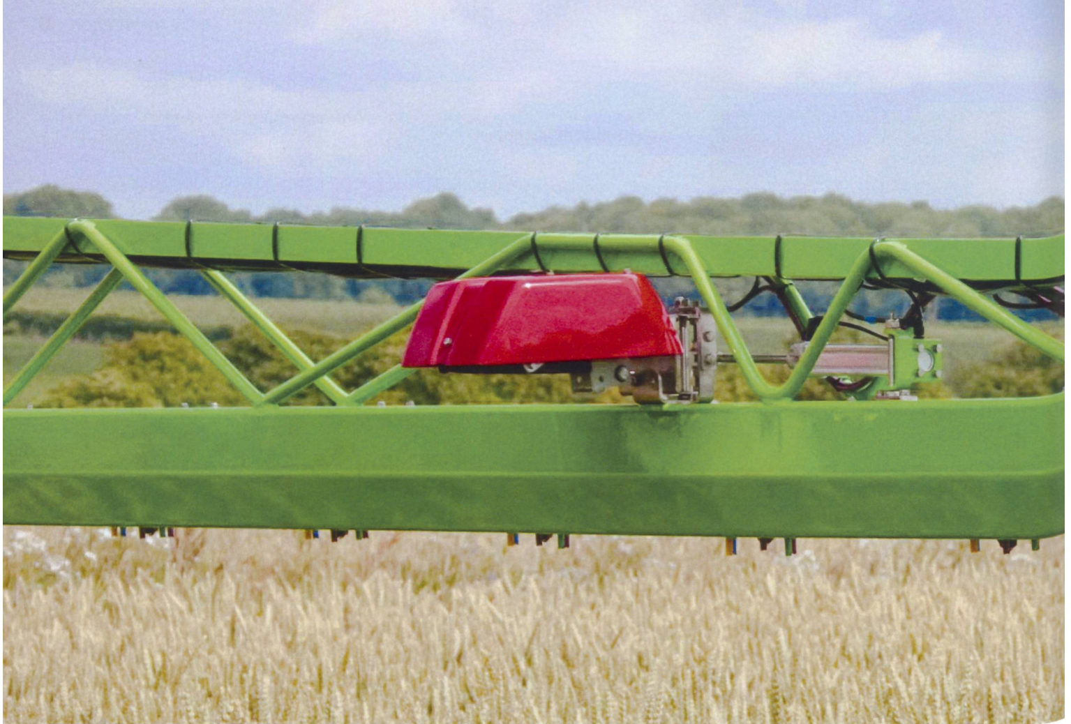
Der abgebildete Messkopf am Gestänge sendet die ermittelten Messwerte an ein Terminal in der Kabine. (Bild: Fritzmeier Umwelttechnik)
