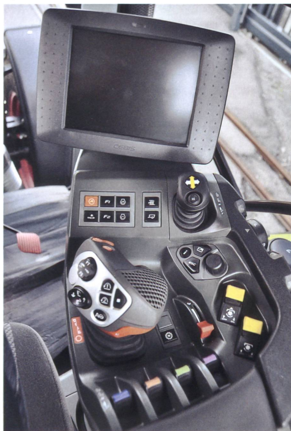
Armlehne mit CMOTION-Fahrhebel und CEBIS-Terminal: Alle Bedienelement befinden sich in Griffnähe.
