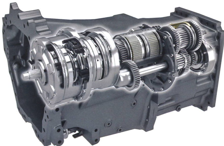
Hexashift-Getriebe mit drei Planetensätzen, für die Lastschaltstufen (links), zwei Lamellenkupplungen für die Wendeschaltung (Mitte) und vier Getriebegruppen (rechts).
