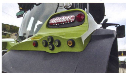
Zapfwelle, Hubwerk und ein Steuergerät lassen sich an den hinteren Kotflügeln bedienen. Für das einschalten der Zapfwelle gibt es Sicherheitsfunktionen.
