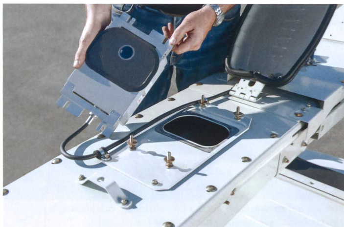
Der NIR-Sensor am Auswurfkrümmen der Claas-Feldhäcksler ist über ein Glasfaserkabel mit dem Spektrometer in der Fahrerkabine verbunden. (Foto: Claas KGaA mbH)
