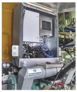
Das NIR-Spektrometer interpretiert die Daten des NIR-Sensors und steuert die Ausbringmenge entsprechend des Nährstoffgehaltes.
