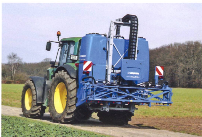
Die sogenannte «Paket-Klappung» ist sehr kompakt, macht die Spritze aber bis drei Meter breit.
