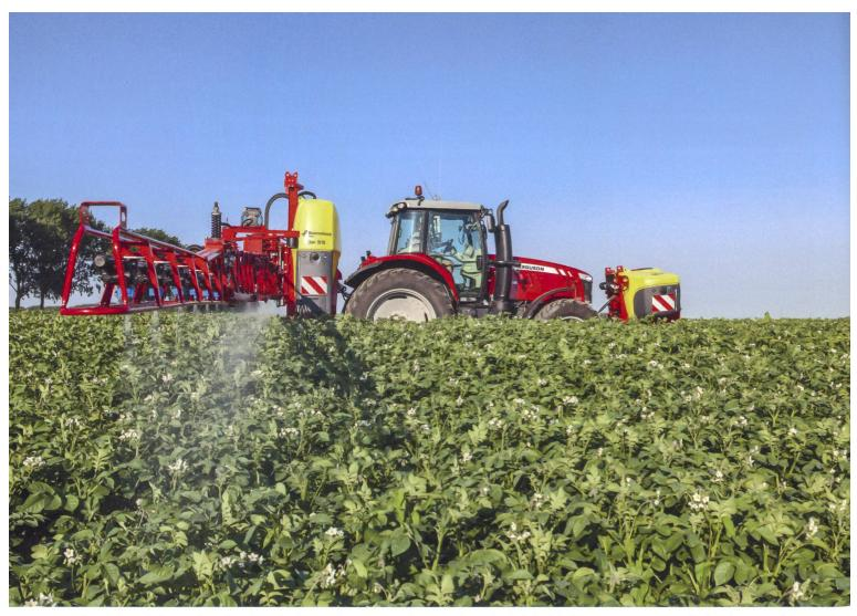
Anbauspritzen haben in der Schweiz nach wie vor eine grosse Bedeutung, denn sie sind dank hohem Ausrüstungsstandard und Fronttank im Vergleich mit Anhänge- oder Selbstfahrspritzen technisch gleichwertig. (Werkbilder)
