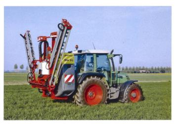
Die ZETA-Klappung von Kverneland erfolgt ausschliesslich vertikal.
