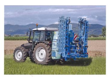
Dieses Gestänge wird horizontal ein- und ausgeschwenkt. Für den Transport wird der ganz Balken vertikal hochgeschwenkt.
