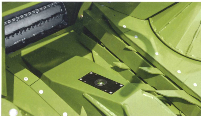
Die fotooptische Zelle in der Mitte des Maisvorsatzes beim BiG X von Krone erfasst den Reifegrad der Maispflanze und sorgt für die automatische Anpassung der Häcksellänge. (Foto: Maschinenfabrik Bernard Krone GmbH)
