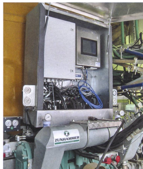
Das NIR-Spektrometer interpretiert die Daten des NIR-Sensors und steuert die Ausbringmenge entsprechend des Nährstoffgehaltes.
