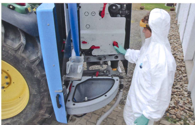
Spritzern werden heute zentral auf einer Seite bedient. Das «Bedienzentrum» wird hinter einem auf- und zuklappbaren Deckel geschützt.
