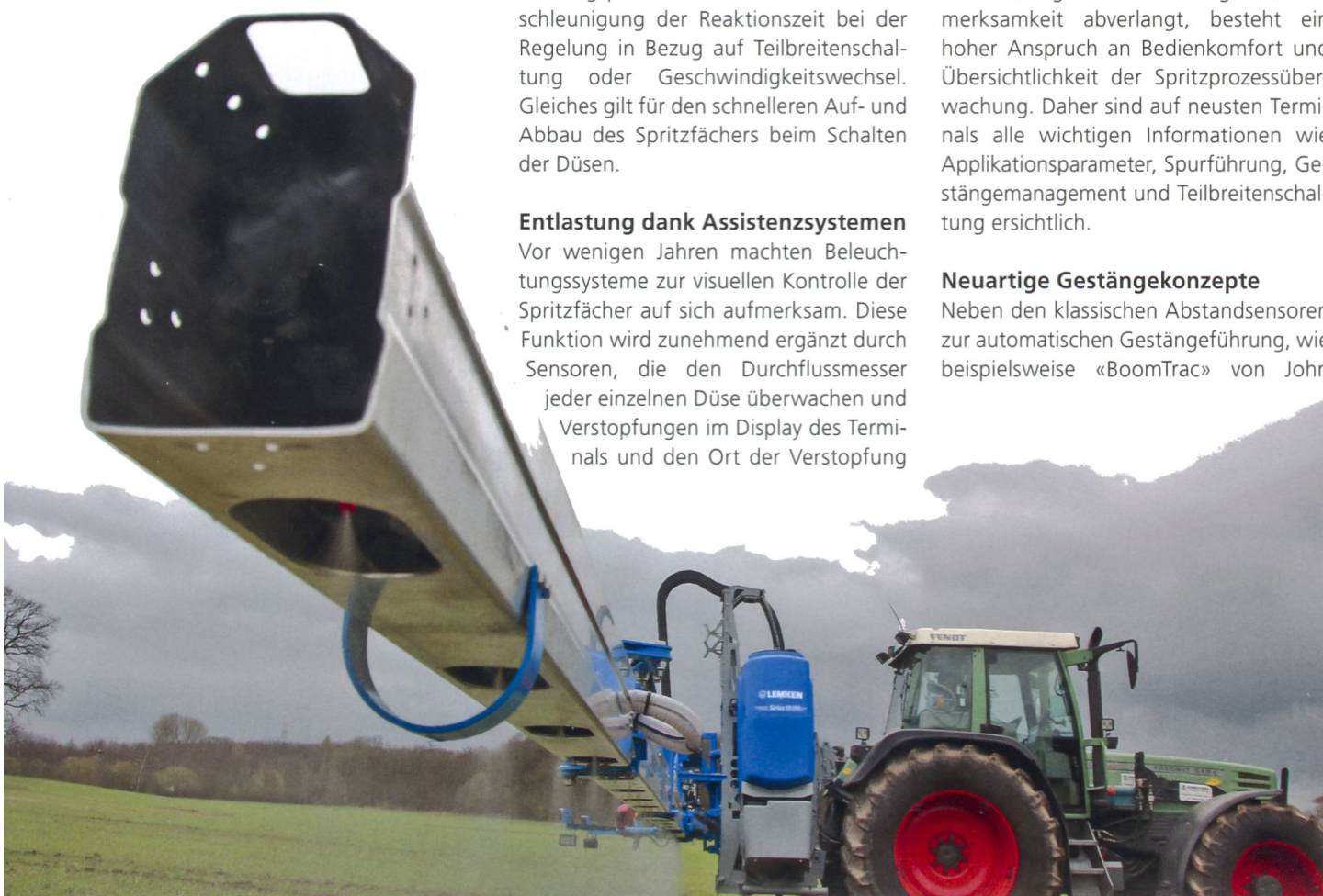
Dank Unterdrückung der horizontalen und vertikalen Gestäμβewegungen wird eine gleichmässige Applikation erreicht.
