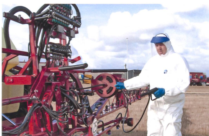
Mit der entsprechenden Ausrüstung erfolgt die Aussenreinigung bereits auf dem Feld, dies bevor Rückstände endgültig angetrocknet sind.
