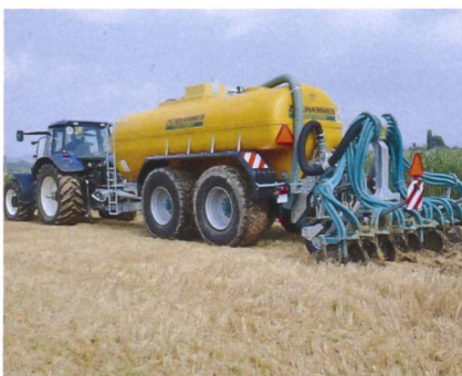
Mit VAN-Control ist ein flächenbezogenes Nährstoff-Management bei der Gülleausbringung möglich.
