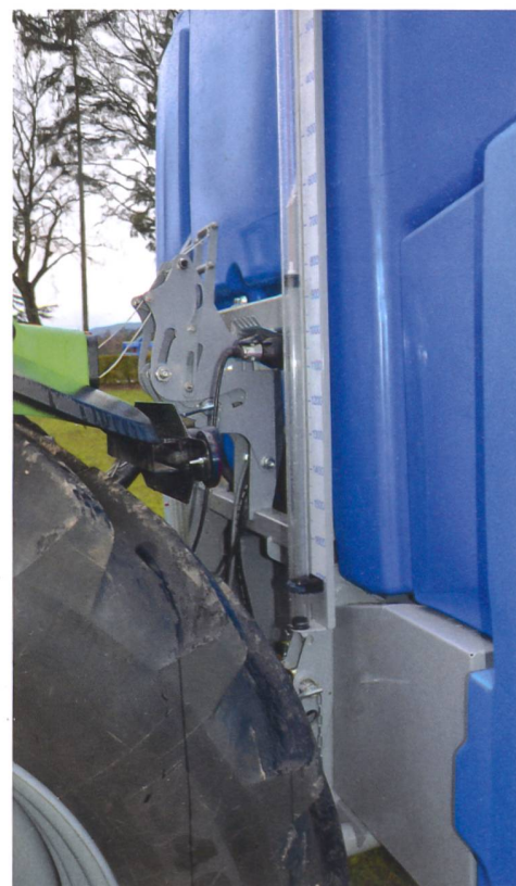
Anbauspritzen lassen wenig Spielraum zum Traktor. Neue Schnellkupplungen und eine günstige Schwerpunktlage verbessern den Anbau und reduzieren den Hubkraftbedarf.
