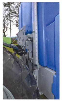
Anbauspritzen lassen wenig Spielraum zum Traktor. Neue Schnellkupplungen und eine günstige Schwerpunktlage verbessern den Anbau und reduzieren den Hubkraftbedarf.
