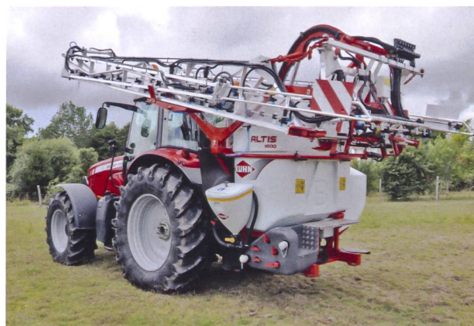
Das hohe, seitliche Zuklappen des Spritzbalkens gibt Freiraum im unteren Bereich der Spritze frei, erhöht aber den Schwerpunkt und die Transporthöhe.
