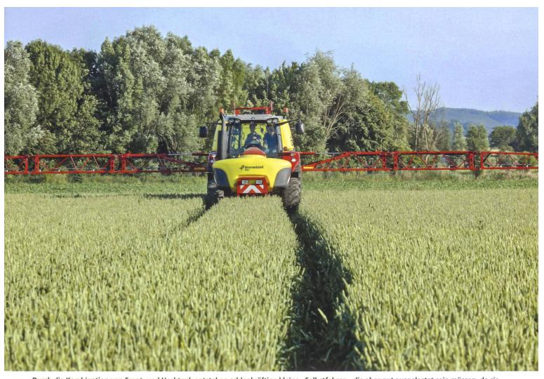
Durch die Kombination von Front- und Hecktank entstehen schlagkräftige kleine «Selbstfahrer», die aber gut ausgelastet sein müssen, da sie einen Traktor binden. (Werkbilder)
