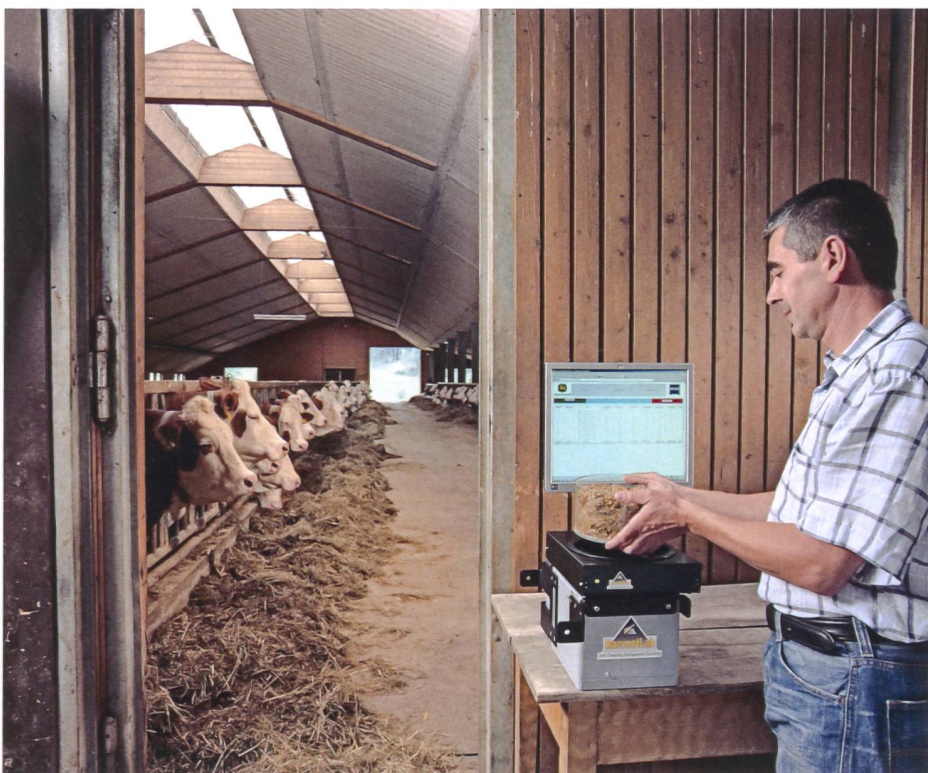
Kompakte NIR-Spektrometer wie der HarvestLab von John Deere können auch als mobiles Silageanalyzelabor eingesetzt werden. (Foto: John Deere GmbH & Co. KG)
