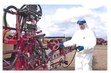
Mit der entsprechenden Ausrüstung erfolgt die Aussenreinigung bereits auf dem Feld, dies bevor Rückstände endgültig angetrocknet sind.
