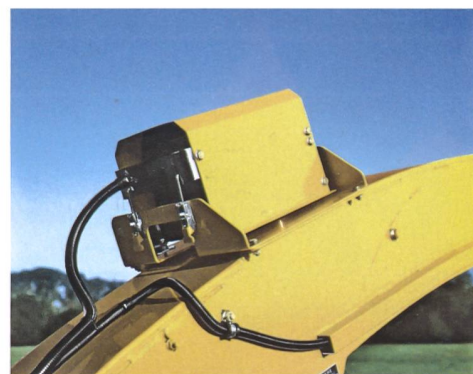
Das gemeinsam mit Zeiss entwickelte kompakte NIR-Spektrometer am Auswurfkrümmer des John-Deere-Feldhäckslers ermöglicht eine Echtzeitanalyse und regelt die Schnittlänge entsprechend dem TS-Gehalt des Häckselstroms. (Foto: John Deere GmbH & Co. KG)
