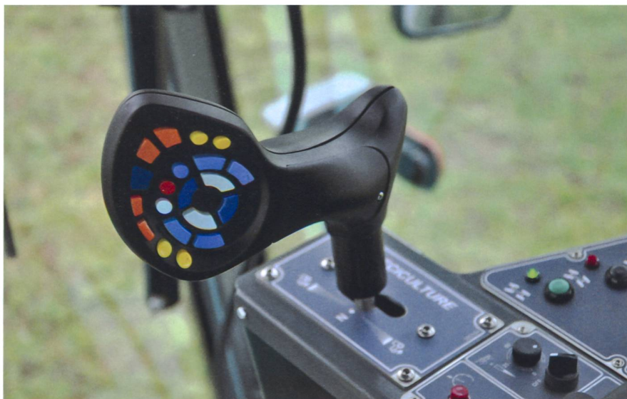
Der drahtlose Multifunktionsjoystick von Berthoud sichert eine Funkverbindung innerhalb einer Reichweite von 25 m.
