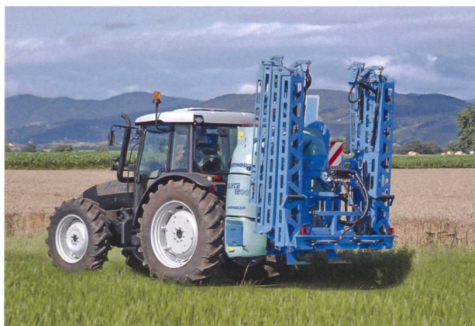
Dieses Gestänge wird horizontal ein- und ausgeschwenkt. Für den Transport wird der ganz Balken vertikal hochgeschwenkt.
