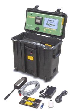
Das NIR-Spektrometer im mobilen Prüflabor von Krone ermöglicht eine schnelle Analyse der Inhaltsstoffe am Feldrand oder im Stall. Am Display des mobilen NIR-Analysegerätes von Krone lassen sich nach etwa einer Minute die Inhaltsstoffe der Probe ablesen.
