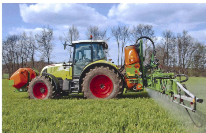
Alle namhaften Hersteller von Anbauspritzern erweitern das Volumen durch Fronttanksysteme.
