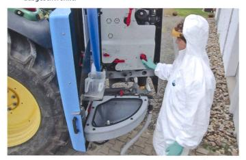
Spritzen werden heute zentral auf einer Seite bedient. Das «Bedienzentrum» wird hinter einem auf- und zuklappbaren Deckel geschützt.
