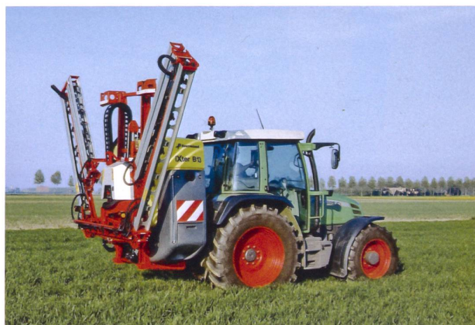
Die ZETA-Klappung von Kverneland erfolgt ausschliesslich vertikal.
