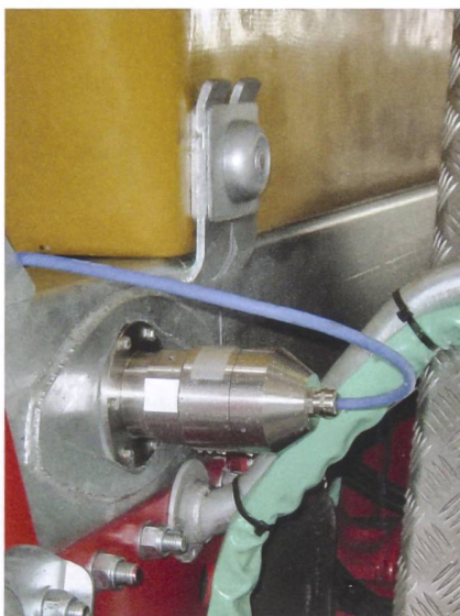
Der NIR-Sensorkopf des Systems VAN-Control von Zunhammer misst bei der Befüllung des Tankwagens die Nährstoffmengen in der Gülle. (Fotos: Zunhammer GmbH)
