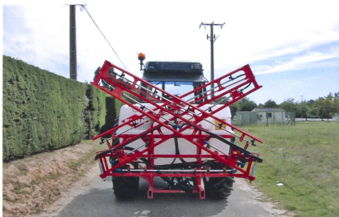
Die X-Klappung ist für technisch einfache Spritzbalken im unteren Preissegment gedacht. Der Balken wird manuell ein- und ausgeschwenkt.
