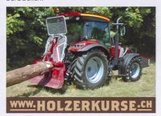
Eine Seilwinde ist für sicheres Arbeiten unerlässlich. Traktoren, die für Rückearbeiten benützt werden, müssen mit einer geprüften Fahrerschutzvorrichtung ausgerüstet sein. Der Fahrer darf die Seilwinde nur von einem sicheren Standort aus, zum Beispiel über Funk, mittels einer langen Leine oder im Fahrerraum, bedienen.
