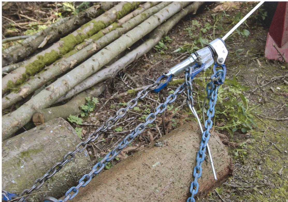
Zum Rücken dürfen nur speziell vergütete Rückeketten verwendet werden. Mit Seilgleitern und Chokerketten lassen sich mehrere Stämme gleichzeitig anhängen. Alle zum Rücken eingesetzten Hilfsmittel, wie Umlenk- und Ablenkrollen, Seilstruppen und Rundschlingen, müssen die zu erwartenden Kräfte aushalten und bestimmungsgemäss verwendet werden. Defekte Teile sind umgehend zu ersetzen.
