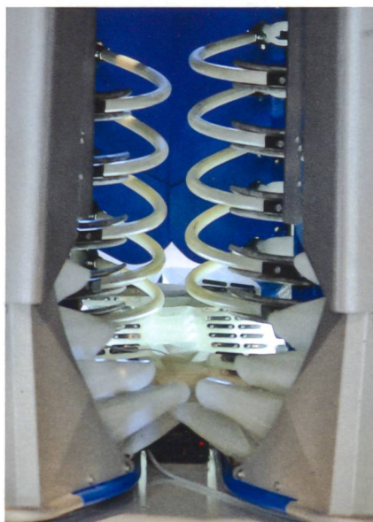
Für die Aufnahme und die Beförderung der Trauben nach dem Rütteln kommen kleine Eimer (links) oder ein Schuppen-Förderband (rechts) zum Einsatz.
