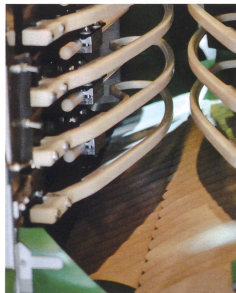
Für die Aufnahme und die Beförderung der Trauben nach dem Rütteln kommen kleine Eimer (links) oder ein Schuppen-Förderband (rechts) zum Einsatz.
