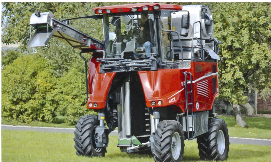
Neu von ERO: seitliches Förderband längs des Traubenvollernters.
