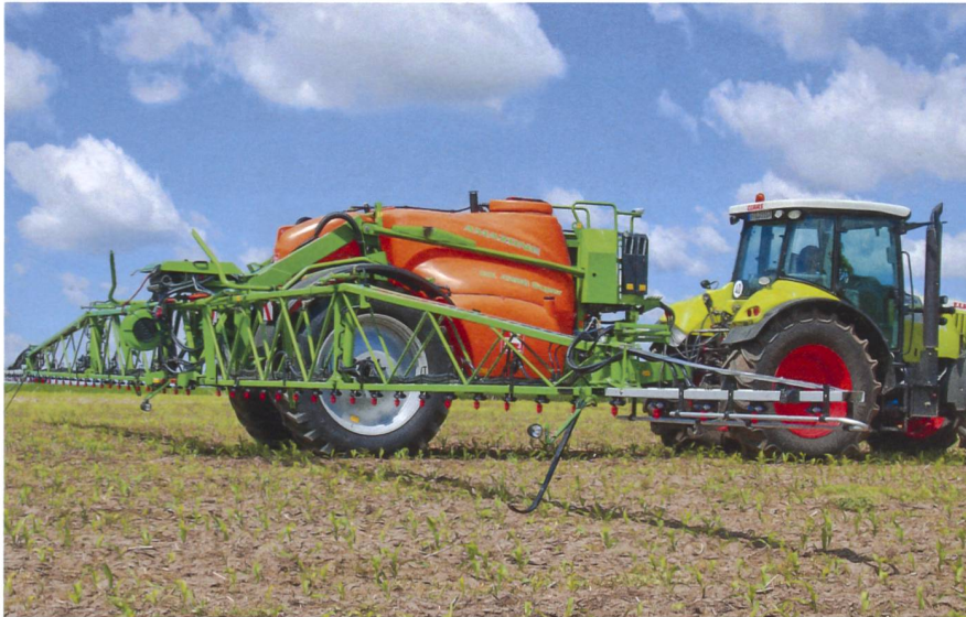
«Telematics ON Implement» ist ein Datenerfassungssystem, das beispielsweise Aufwandsmengen, Spritzdruck oder Fahrgeschwindigkeit in Echtzeit ins Büro liefert und damit einen Beitrag zur betriebswirtschaftlichen Transparenz leistet. (Bild zVg)
